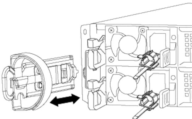
A imagem seguinte mostra a remoção do módulo do controlador afetado do chassis:
