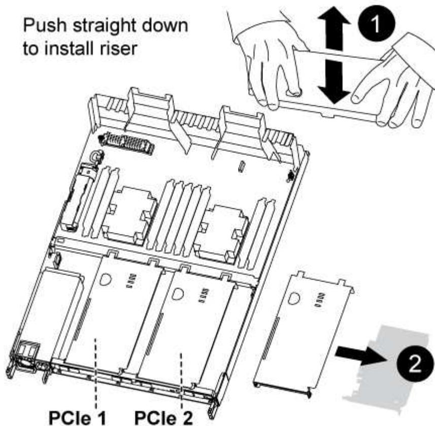
1. Remova a tampa sobre os risers PCIe desapertando o parafuso de aperto manual azul na tampa, deslize
