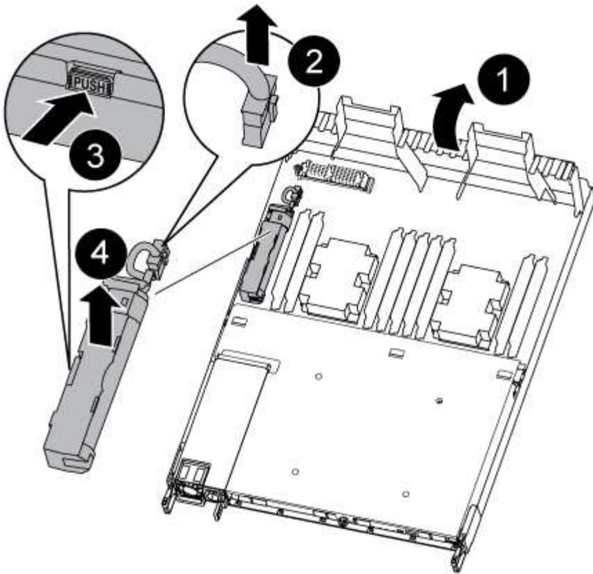
1. Abra a conduta de ar e localize a bateria NVDIMM.
