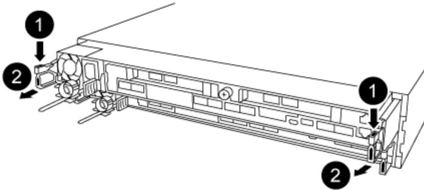
1. Insira o indicador no mecanismo de travamento em ambos os lados do módulo do controlador.
