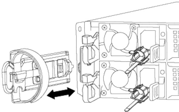
Deixe os cabos no dispositivo de gerenciamento de cabos para que, ao reinstalar o dispositivo de gerenciamento de cabos, os cabos sejam organizados.
