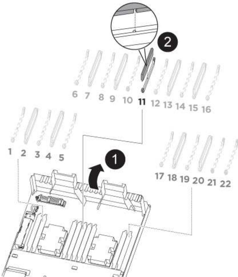
1. Abra a conduta de ar e, em seguida, localize o NVDIMM no slot 11 do módulo do controlador.
