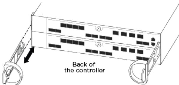
Deixe os cabos no dispositivo de gerenciamento de cabos para que, ao reinstalar o dispositivo de gerenciamento de cabos, os cabos sejam organizados.
