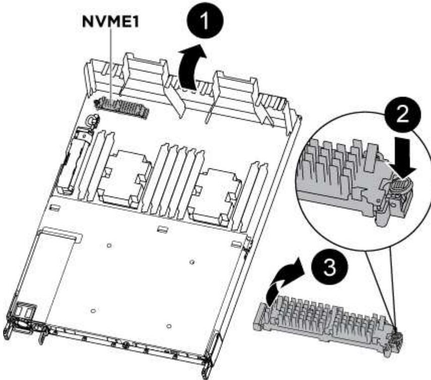
1. Abra a conduta de ar e localize o suporte de arranque utilizando a seguinte ilustração ou o mapa da FRU no módulo do controlador:
