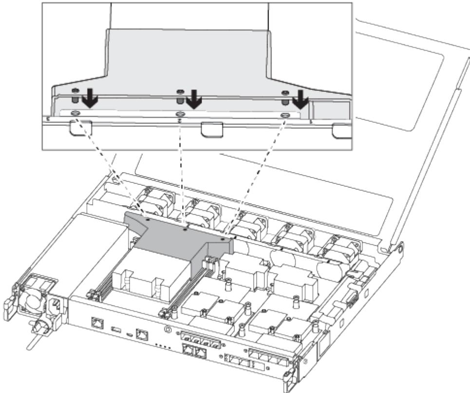
2. Feche a tampa do módulo do controlador e aperte o parafuso de aperto manual.
