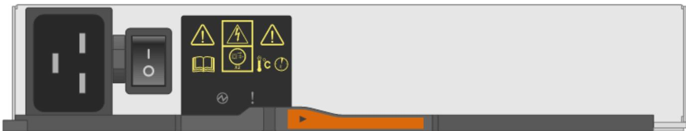
A ilustração a seguir refere-se a uma fonte de alimentação usada em um compartimento de disco de DS224C GB ou DS212C GB:
