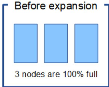
Para expandir o site neste exemplo, é recomendável adicionar três ou mais nós de storage novos. O StorageGRID precisa de três nós de storage para codificação de apagamento em mais de 1 horas por dia, 2 dias por semana, para que ele possa colocar os dois fragmentos de dados e um fragmento de paridade em nós diferentes.
