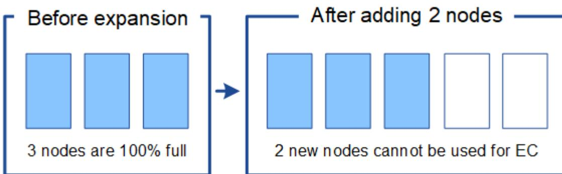
Para resolver esse problema e usar os novos nós de storage, é possível executar o procedimento de rebalanceamento de EC. Quando esse procedimento é executado, o StorageGRID redistribui dados
