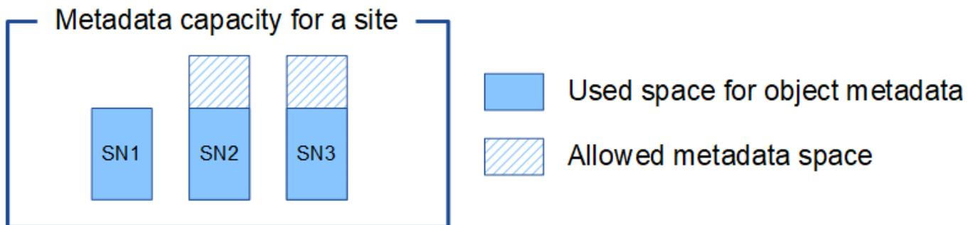
Da mesma forma, como o StorageGRID mantém todos os metadados de objetos para um sistema StorageGRID em cada local, a capacidade geral de metadados de um sistema StorageGRID é determinada pela capacidade de metadados de objetos do menor local.
