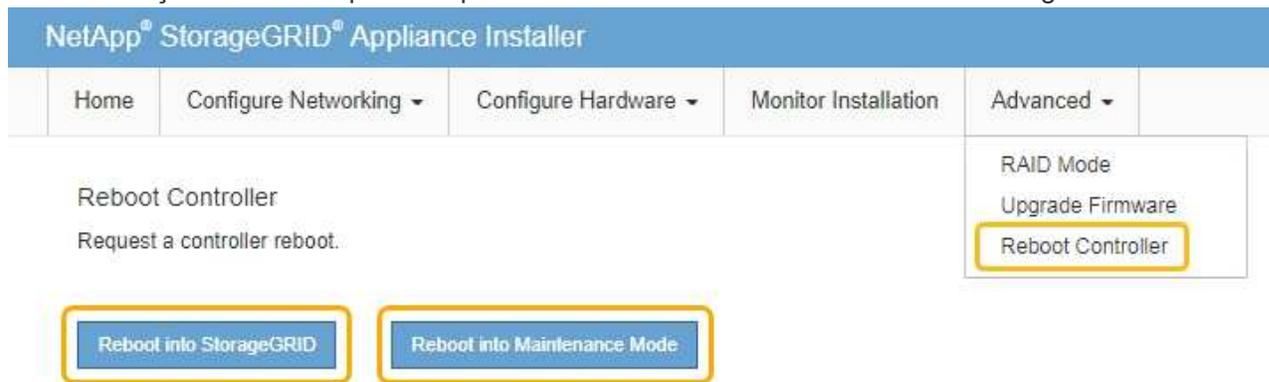
Pode demorar até 20 minutos para o aparelho reiniciar e voltar a ligar a grelha. Para confirmar que a reinicialização está concluída e que o nó voltou a ingressar na grade, volte ao Gerenciador de Grade. A guia **nós** deve exibir um status normal ✓ para o nó do dispositivo, indicando que não há alertas ativos e o nó está conetado à grade.
