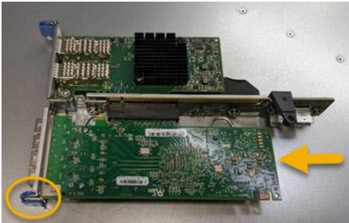
Há dois adaptadores no conjunto da riser: Um HBA Fibre Channel e um adaptador de rede Ethernet. A HBA Fibre Channel é indicada na ilustração.
