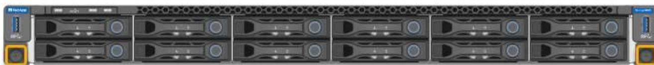
5. Deslize o controlador SG6000-CN para a frente para fora do rack até que os trilhos de montagem estejam totalmente estendidos e você ouvir os trincos em ambos os lados clicarem.
