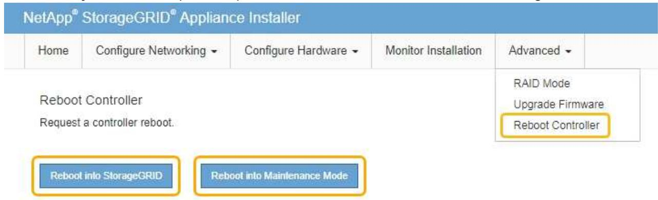
Pode demorar até 20 minutos para o aparelho reiniciar e voltar a ligar a grelha. Para confirmar que a reinicialização está concluída e que o nó voltou a ingressar na grade, volte ao Gerenciador de Grade. A guia **nós** deve exibir um status normal ✓ para o nó do dispositivo, indicando que não há alertas ativos e o nó está conectado à grade.
