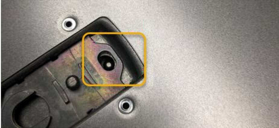
2. Rode o trinco da tampa para a frente e para baixo até parar e a tampa assentar totalmente no chassi. Verifique se não existem folgas ao longo da extremidade dianteira da tampa.
