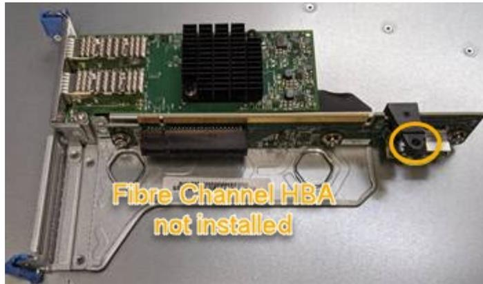
5. Posicione o conjunto da riser no chassi, certificando-se de que ele se alinha com o conector e o pino guia na placa de sistema; em seguida, insira o conjunto da riser.
