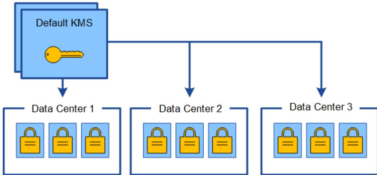
3. Você decide adicionar um KMS específico para um site (Data Center 3 na figura). No entanto, como os nós do appliance já estão criptografados, um erro de validação ocorre quando você tenta salvar a configuração para o KMS específico do site. O erro ocorre porque o KMS específico do site não tem a chave correta para descriptografar os nós nesse site.
