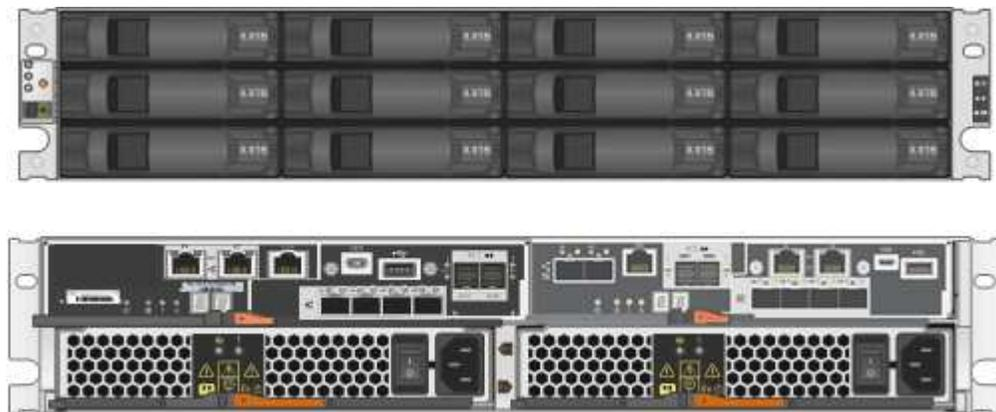
O SG5712X inclui dois controladores e dois coletores de ventilador.
