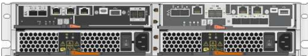
O SG5712 inclui dois controladores e dois coletores de ventilador.
