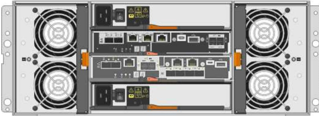
O SG5760 inclui dois controladores, dois coletores de ventilador e dois coletores de energia.
