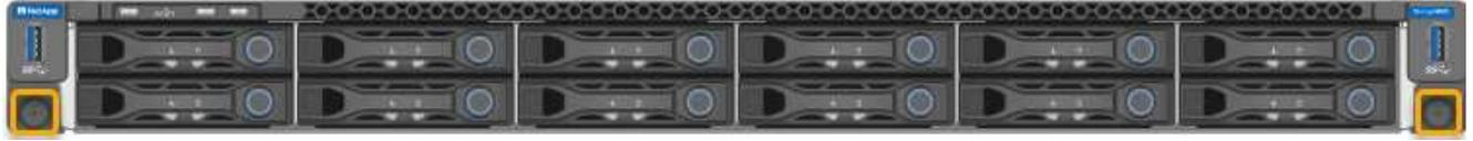
5. Deslize o controlador SG6000-CN para a frente para fora do rack até que os trilhos de montagem estejam totalmente estendidos e você ouvir os trincos em ambos os lados clicarem.
