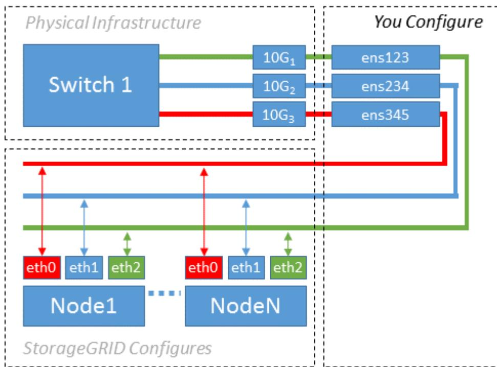
O sistema operacional Linux cria as ensXYZ interfaces automaticamente durante a instalação ou inicialização, ou quando as interfaces são hot-added. Não é necessária nenhuma configuração além de garantir que as interfaces estejam configuradas para serem criadas automaticamente após a inicialização. Você tem que determinar qual ensXYZ corresponde à rede StorageGRID (Grade, Administrador ou Cliente) para que você possa fornecer os mapeamentos corretos posteriormente no processo de configuração.
