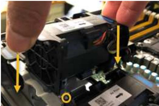
8. Pressione firmemente o conector da ventoinha na placa de circuito impresso.
