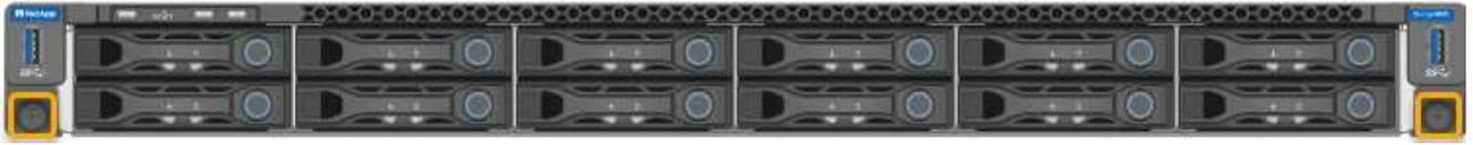
5. Deslize o SG110 ou SG1100 para a frente para fora do rack até que os trilhos de montagem estejam totalmente estendidos e você ouça os trincos em ambos os lados estalarem.
