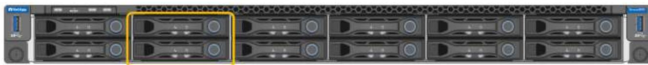
As duas unidades de estado sólido (SSDs), indicadas pelo contorno laranja, são usadas para armazenar o sistema operacional StorageGRID e são espelhadas usando RAID 1 para redundância. Quando o dispositivo de serviços SG100 ou SG1000 é configurado como um nó Admin, essas unidades podem ser usadas para armazenar logs de auditoria, métricas e tabelas de banco de dados.
