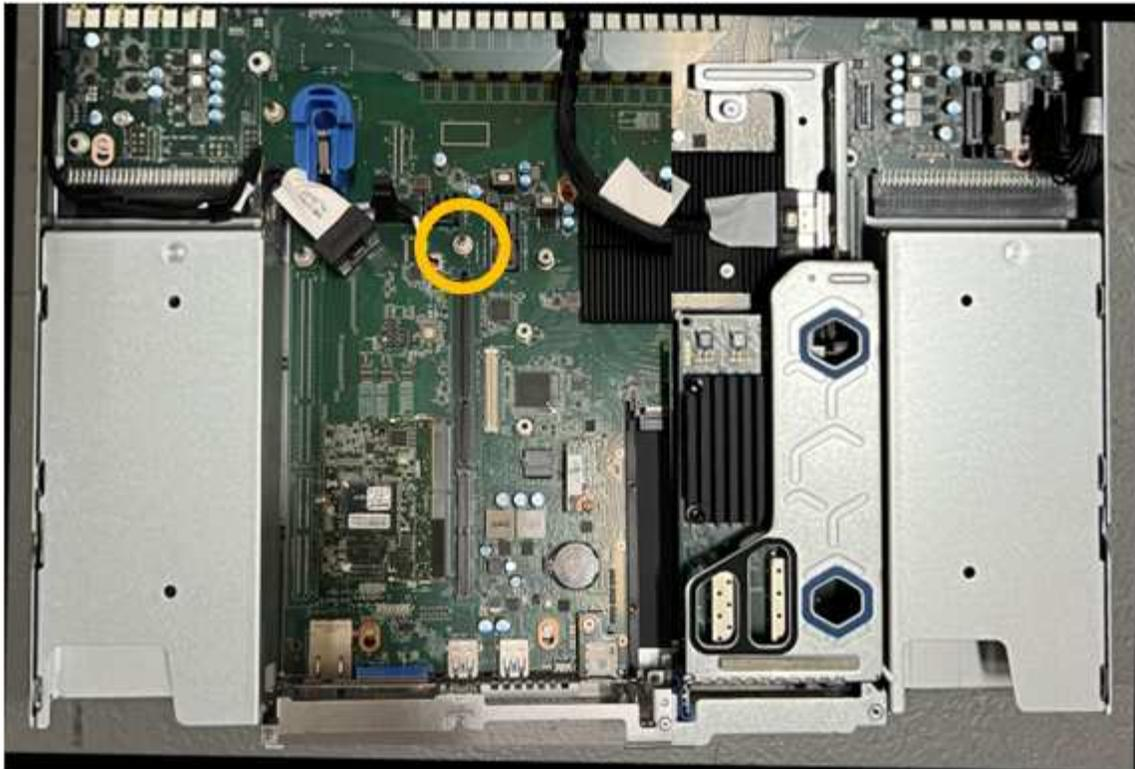
6. Posicione o conjunto da riser no chassi, certificando-se de que ele se alinha com o conector na placa de sistema e o pino guia.
