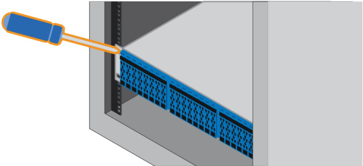
6. Fixe o compartimento na parte de trás dos trilhos inserindo dois parafusos M5 através dos suportes no compartimento e no suporte do kit de trilho.
