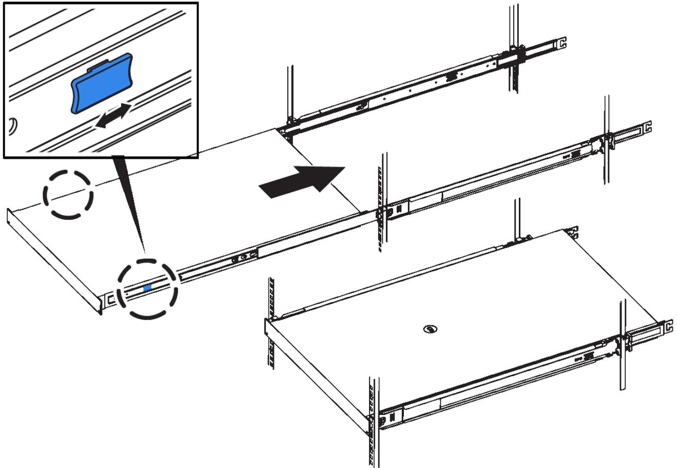
5. Aperte os parafusos integrados no painel frontal do aparelho para fixar o aparelho no rack.
