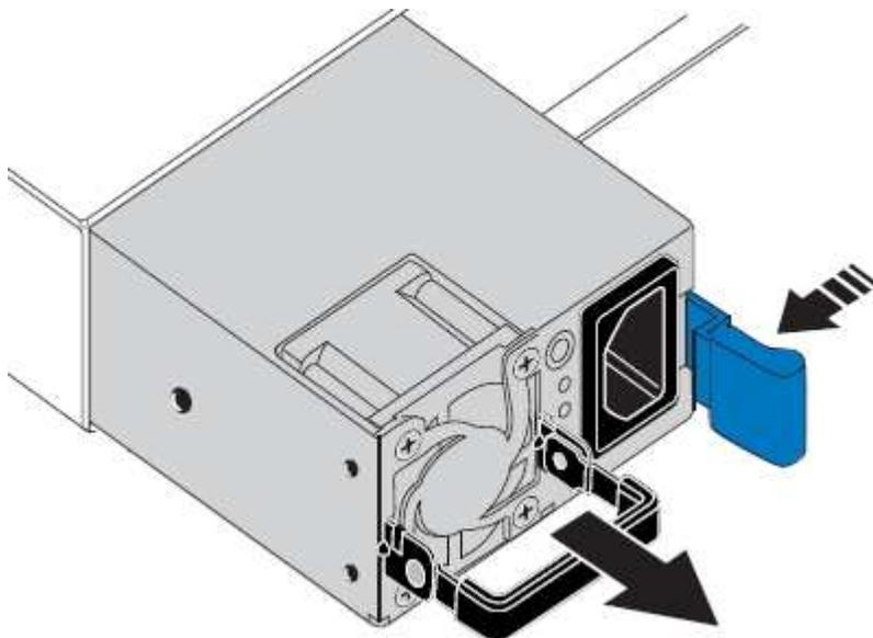
5. Com o trinco azul à direita, deslize a fonte de alimentação de substituição para o chassis.
