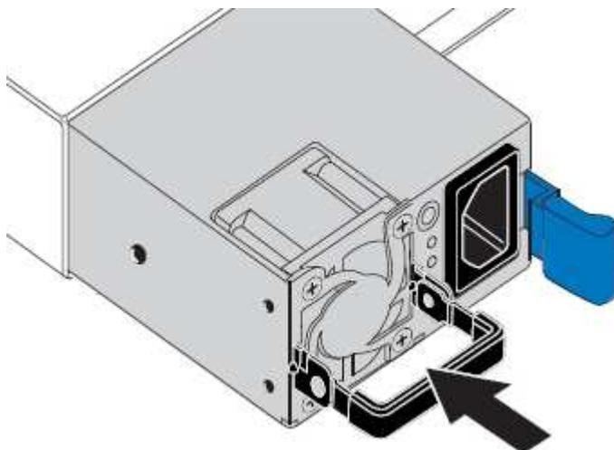
6. Empurre o manípulo do came para baixo para fixar a fonte de alimentação de substituição.
