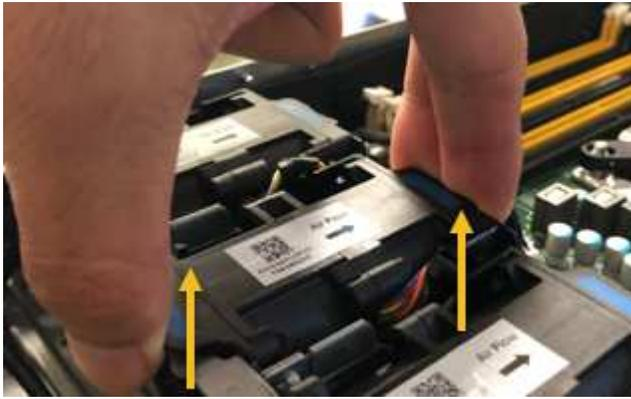
7. Faça deslizar a ventoinha de substituição para a ranhura aberta no chassis.
