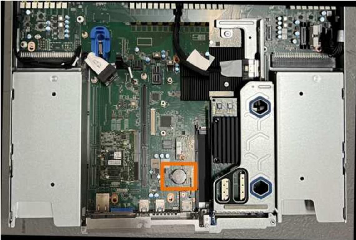
6. Use o dedo ou uma ferramenta de alavanca de plástico para pressionar o clipe de retenção (destacado) para longe da bateria para prendê-lo da tomada.
