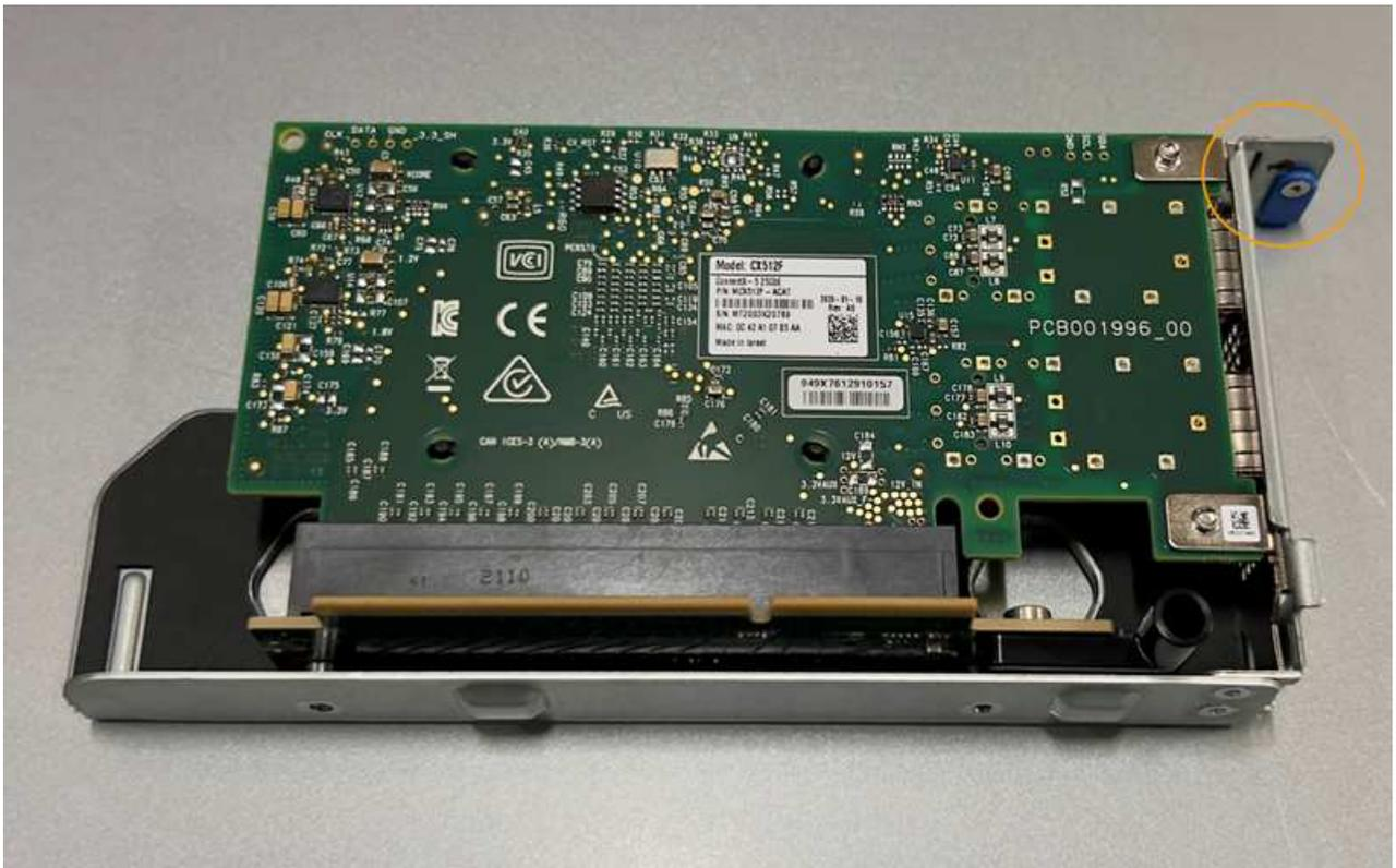
5. Abra a trava azul (circulada) na placa de rede a ser substituída e remova cuidadosamente a placa de rede do conjunto da riser. Agite ligeiramente a placa de rede para ajudar a remover a placa de rede do respectivo conector. Não use força excessiva.
