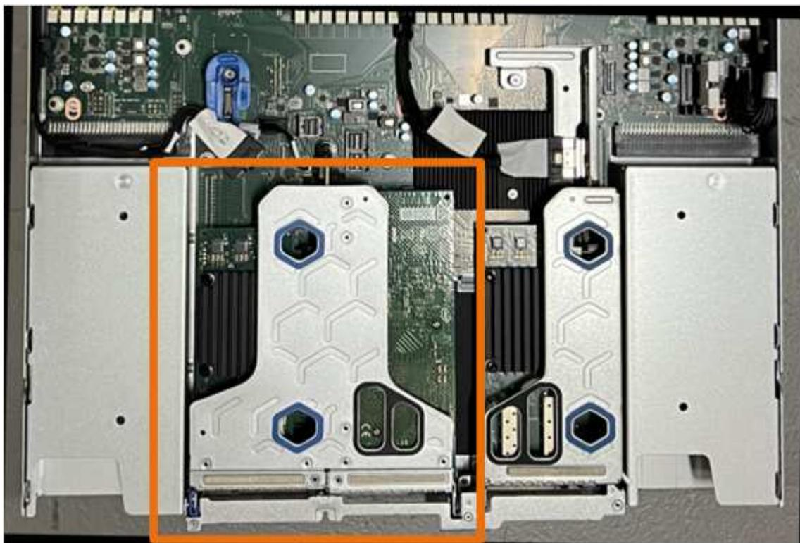
3. Segure o conjunto da riser através dos orifícios marcados a azul e levante-o cuidadosamente para cima. Mova o conjunto da riser em direção à frente do chassi enquanto o levanta para permitir que os conectores externos em suas NICs instaladas evitem o chassi.
