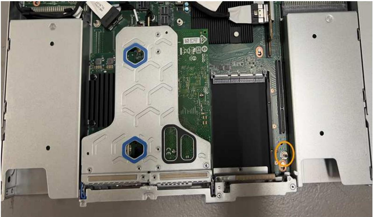
e. Posicione o conjunto da riser de um slot no chassi, certificando-se de que ele se alinha com o conector na placa de sistema e o pino guia.
