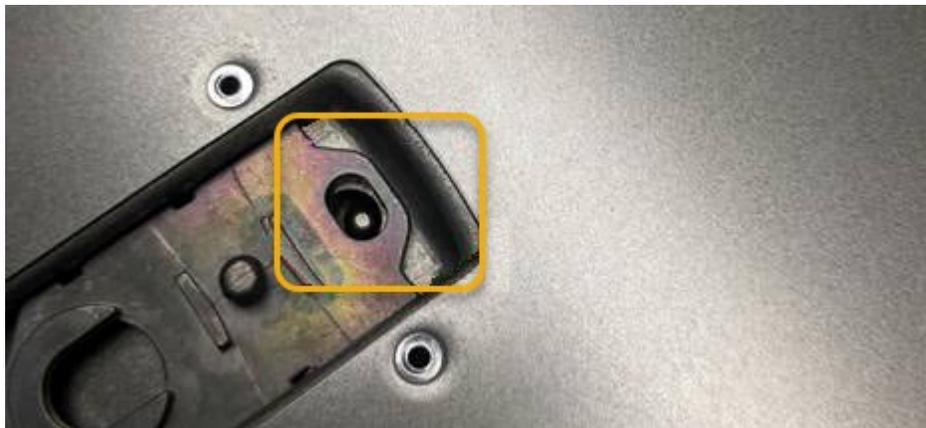
2. Rode o trinco da tampa para a frente e para baixo até parar e a tampa assentar totalmente no chassis. Verifique se não existem folgas ao longo da extremidade dianteira da tampa.
