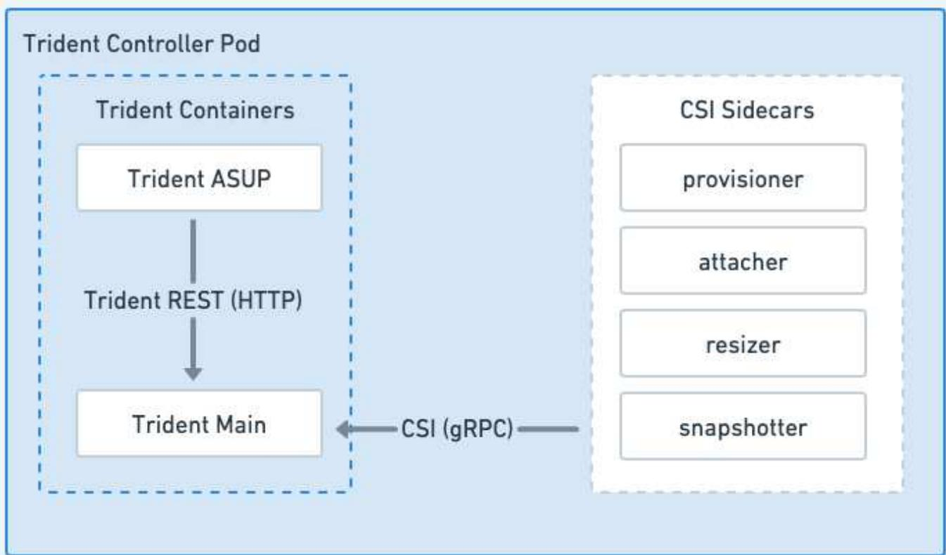
**Figura 2. Diagrama do pod do controlador Trident**
