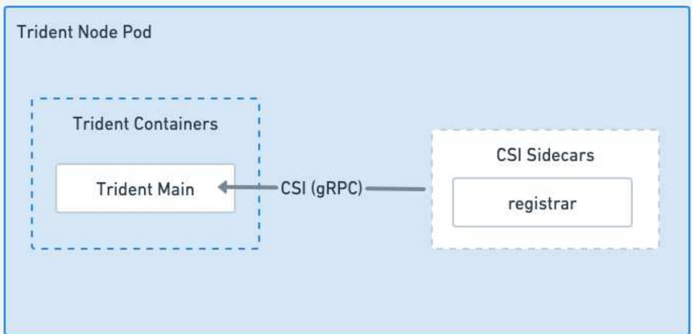
Figura 3. Diagrama do pod do nó Trident
