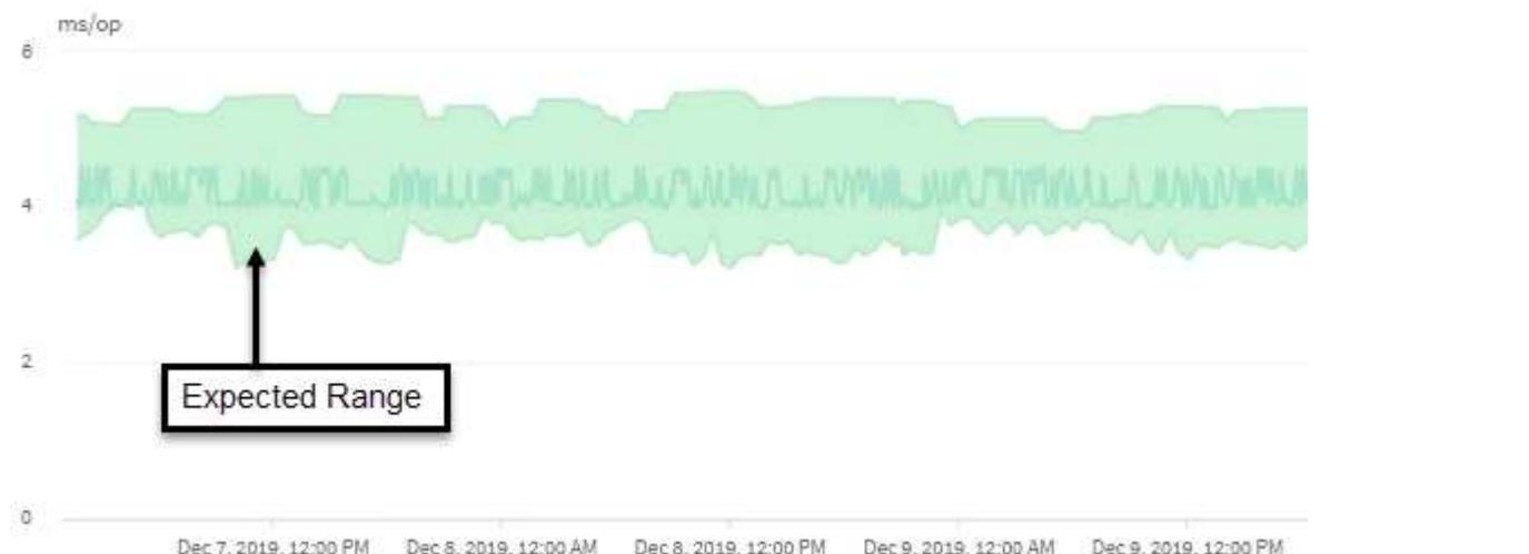
在此示例中，卷的延迟预测（以灰色显示）最低为每个操作 3.5 毫秒（毫秒 / 操作），最高为 5.5 毫秒 / 操作。如果由于网络流量间歇性峰值或集群组件上的争用，实际延迟（以蓝色显示）突然增加到 10 毫秒 / 操作，则该延迟将高于延迟预测并超过动态性能阈值。
