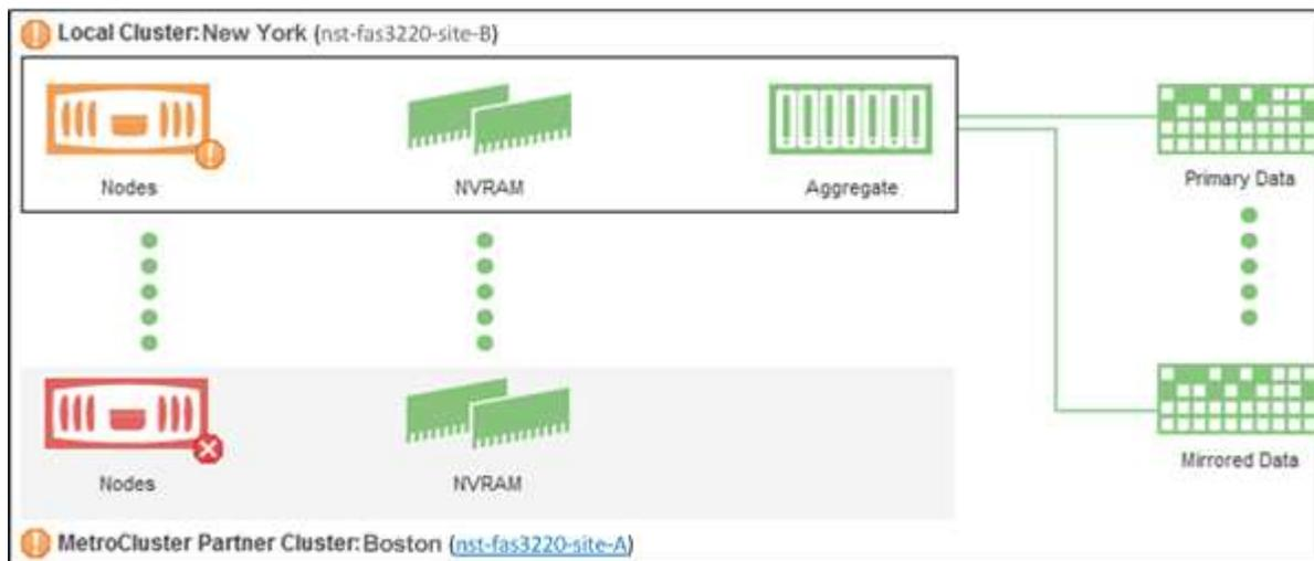
在此示例中，如果本地或配对集群上的 NVRAM 图标为黄色或红色，则带有 NVRAM 的运行状况问题描述可能已导致出现性能事件。如果页面上没有红色或黄色图标，则配对集群上的性能问题描述可能已导致此性能事件。
