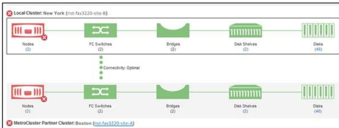
在此示例中，将显示本地集群及其配对集群的名称和组件。黄色或红色图标表示突出显示的组件的运行状况事件。连接图标表示集群之间的链接。您可以将鼠标光标指向一个图标以显示事件信息，也可以单击该图标
