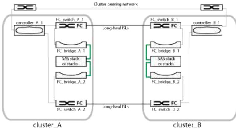
双节点配置由两个集群组成，每个集群位于不同地理位置的站点上。cluster\_A 位于第一个 MetroCluster 站点。cluster\_B 位于第二个 MetroCluster 站点。每个站点都有一个 SAS 存储堆栈。支持更多存储堆栈，但每个站点仅显示一个存储堆栈。
