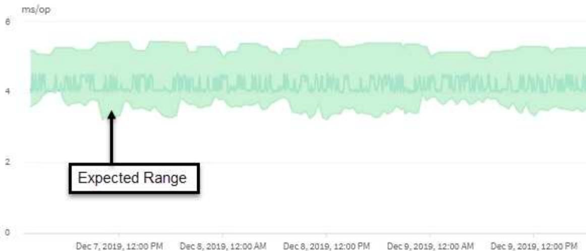
在此示例中，卷的延迟预测（以灰色显示）最低为每个操作 3.5 毫秒（毫秒 / 操作），最高为 5.5 毫秒 / 操作。如果由于网络流量间歇性峰值或集群组件上的争用，实际延迟（以蓝色显示）突然增加到 10 毫秒 / 操作，则该延迟将高于延迟预测并超过动态性能阈值。
