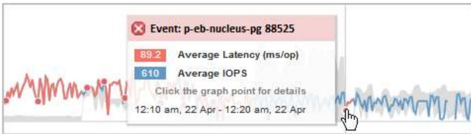
在此示例中，事件由一个红点(●)。将鼠标光标悬停在红点上方会显示一个弹出窗口、其中包含有关事件的更多详细信息以及用于分析事件的选项。
