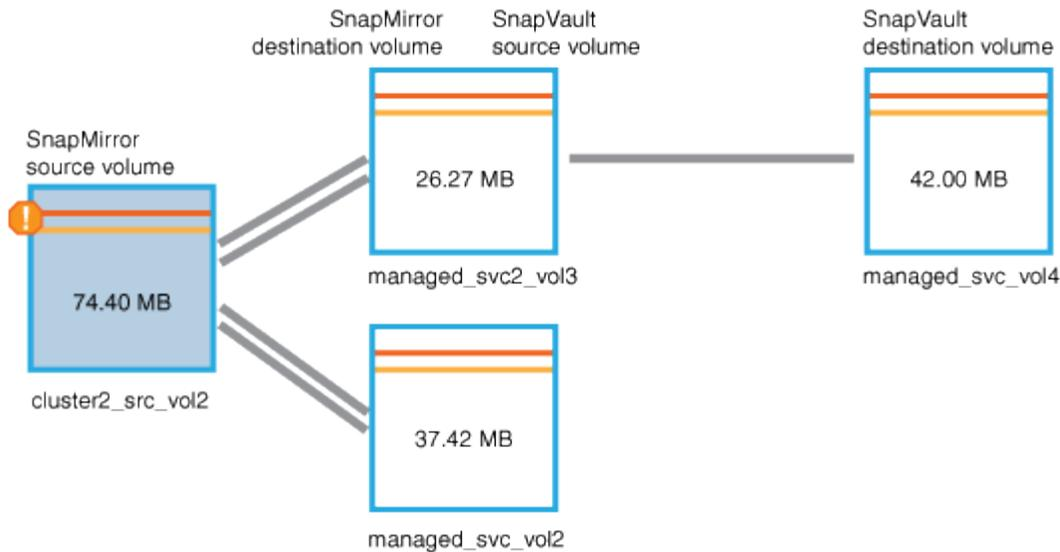
5. 将光标置于错误图标上方可看到弹出对话框，其中显示阈值设置，并显示卷已超过错误阈值，指示容量问题描述。
