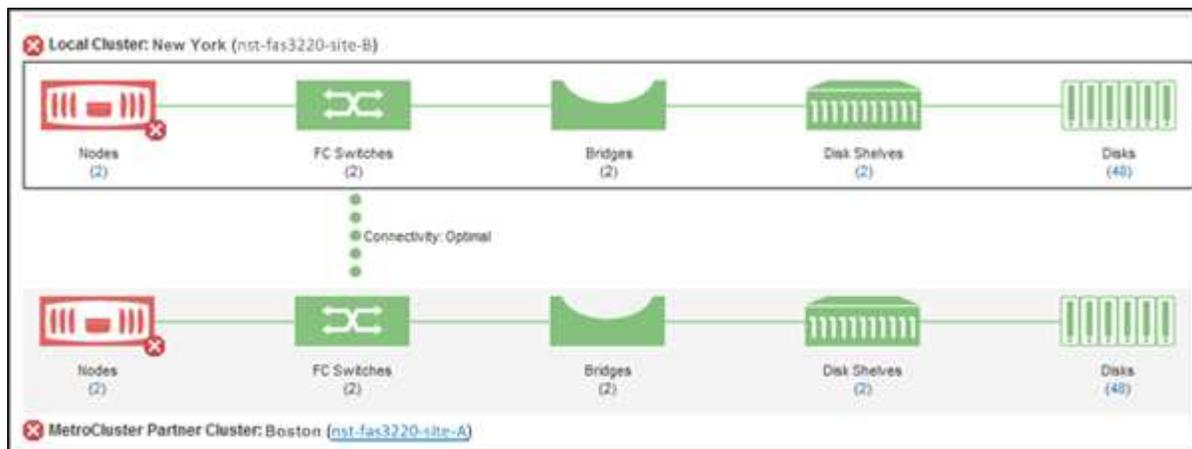
在此示例中，将显示本地集群及其配对集群的名称和组件。黄色或红色图标表示突出显示的组件的运行状况事件。连接图标表示集群之间的链接。您可以将鼠标光标指向一个图标以显示事件信息，也可以单击该图标以显示事件。任一集群上的运行状况问题描述可能已导致性能事件。
