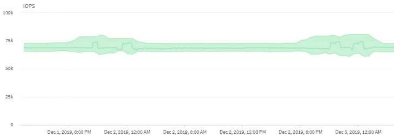
此示例显示了 IOPS 图表。实际操作统计信息为蓝线，操作统计信息的 IOPS 预测为绿色。
