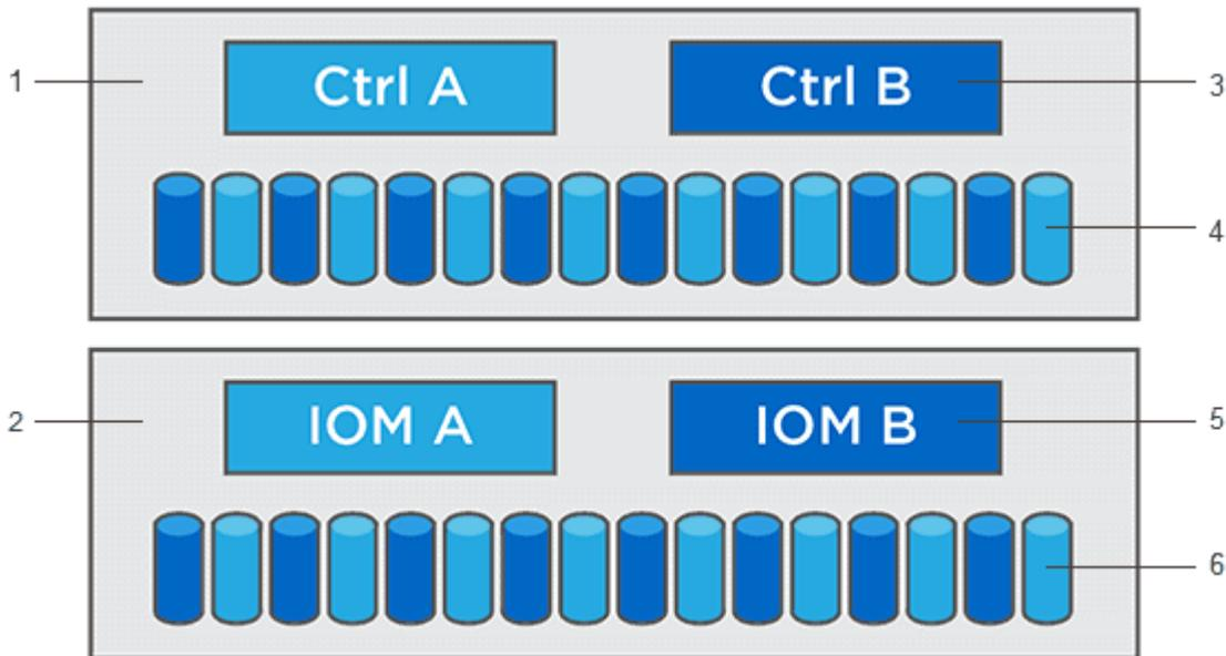
1控制器架；2驱动器架；3软件、控制器固件、控制器NVSRAM、监控软件；4驱动器固件；5 IOM固件；6驱动器固件
