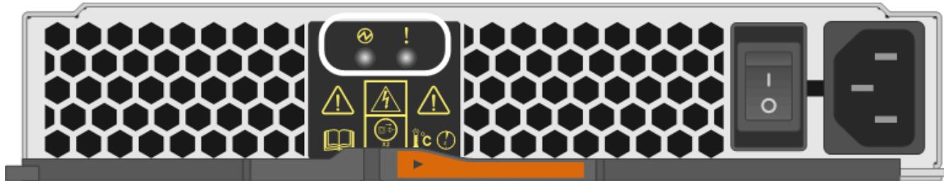
◦ 电源 LED：如果呈 \* 稳定绿色 \*，则表示电源运行正常。如果为 \* 关 \*，则表示电源出现故障，交流电源开关已关闭，交流电源线安装不正确或交流电源线输入电压不在边界内（交流电源线源端存在问题）。
