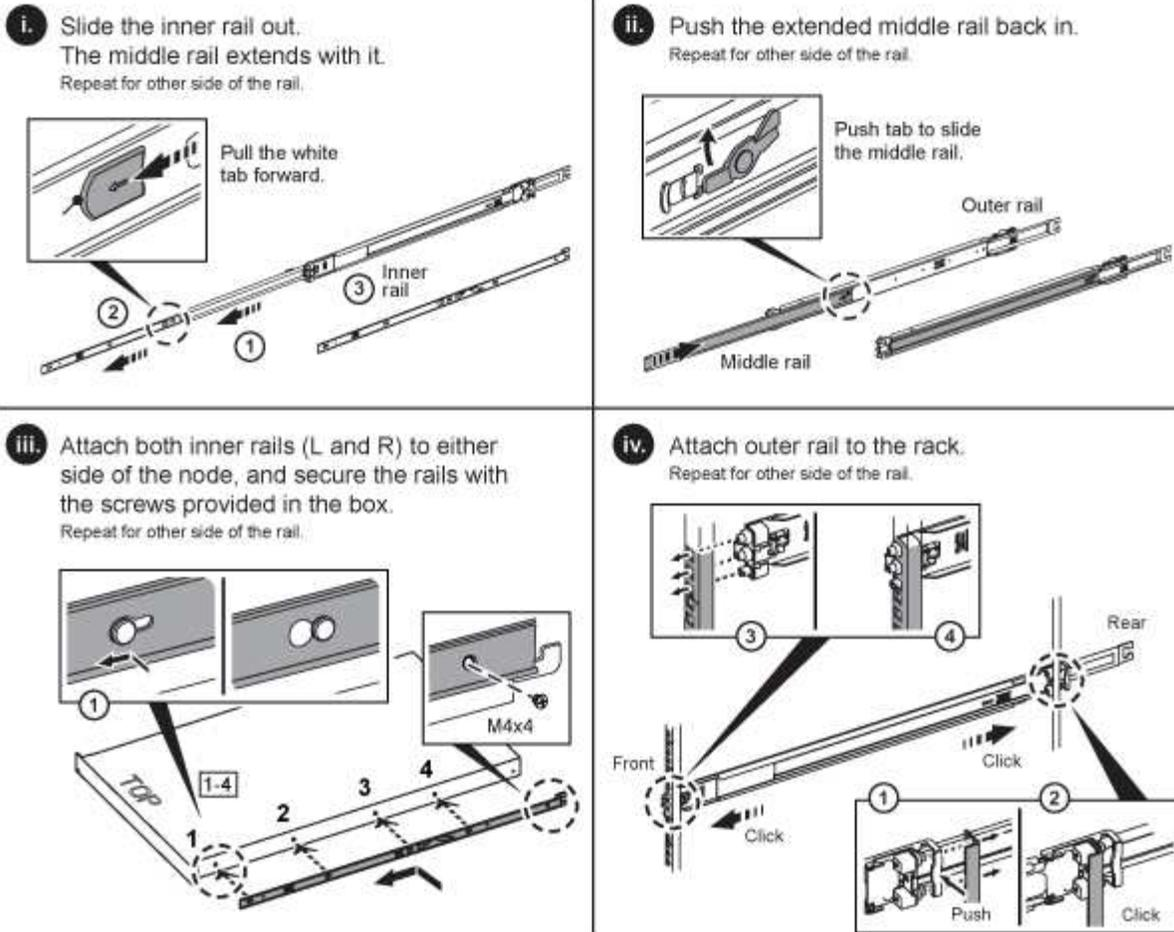
H610S 上有左右导轨。将螺钉孔朝底部放置，以便 H610S 翼形螺钉可以将机箱固定到导轨上。
