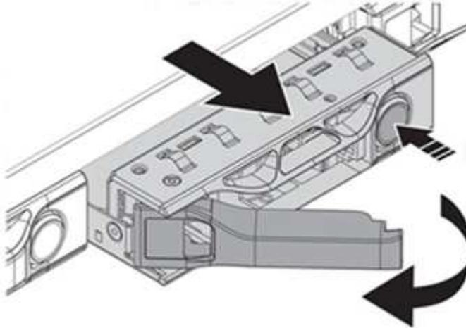
**i** 在尝试将驱动器滑出机箱之前，请确保托盘把手已完全打开。
