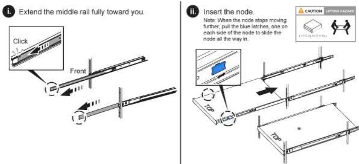
⚠ 抬起硬件并将其安装到机架时，请务必小心。一个 H610S 机箱重 40.5 磅（18.4 千克）。
