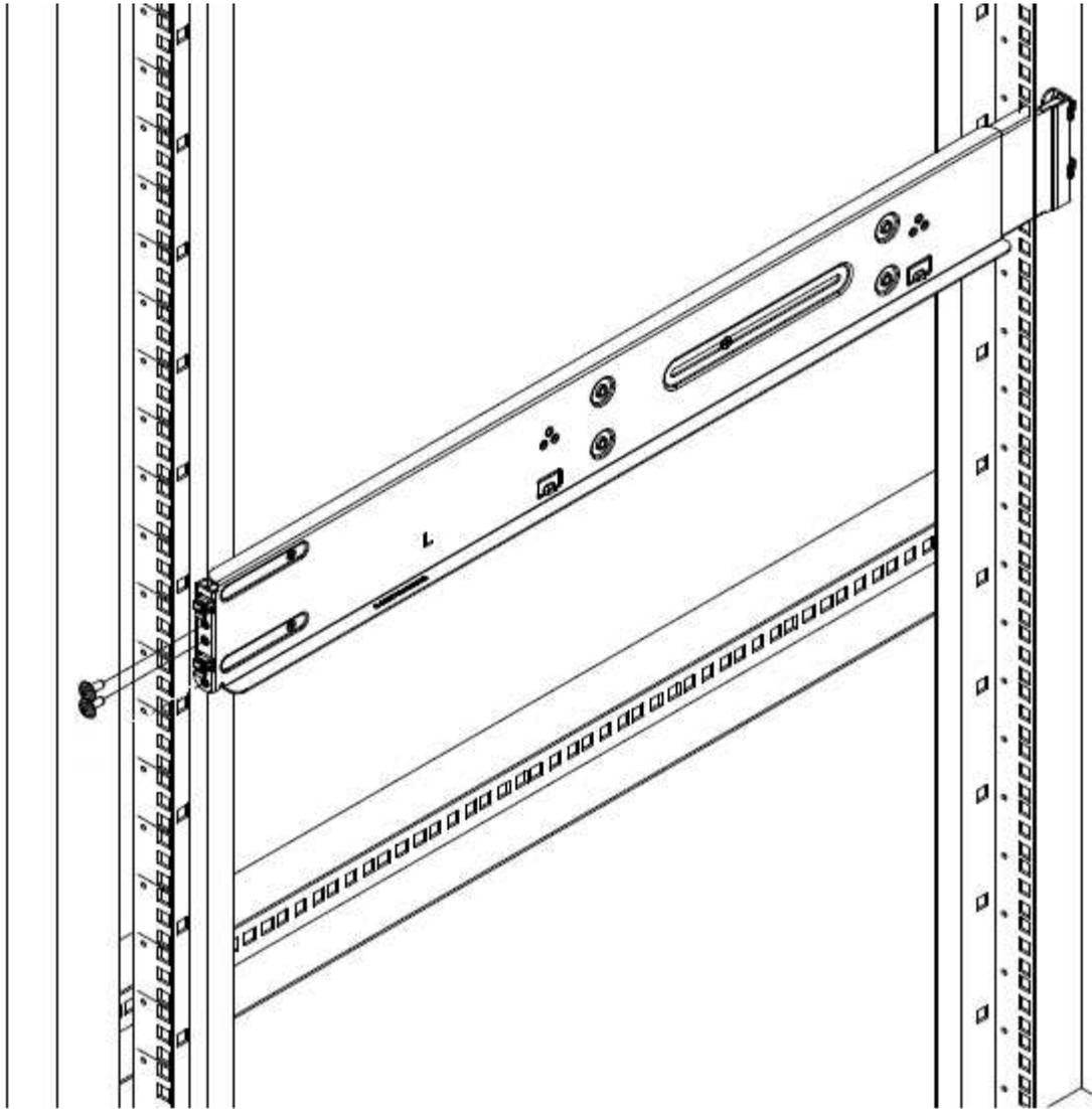
4. 将导轨的后部延伸至机架的后柱。
