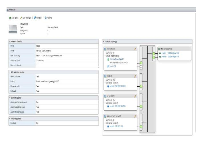
62. 选择 VMkernel NIC 选项卡以确认已配置的虚拟适配器。列出的适配器应类似于以下示例:
