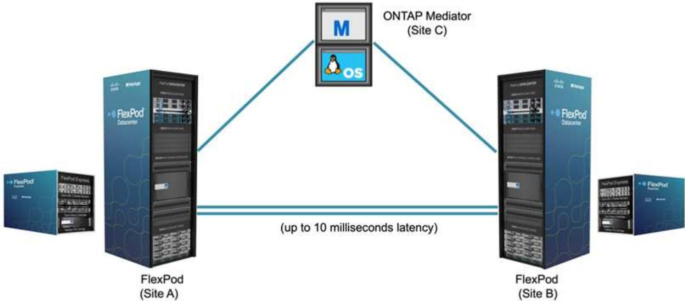
借助 FlexPod SM-BC 解决方案，您可以在分布式且集成的基础架构上部署基于 VMware vSphere 的私有云。通过集成的解决方案，可以将多个站点作为一个解决方案基础架构进行协调，以保护数据服务免受各种单点故障情形和整个站点故障的影响。
