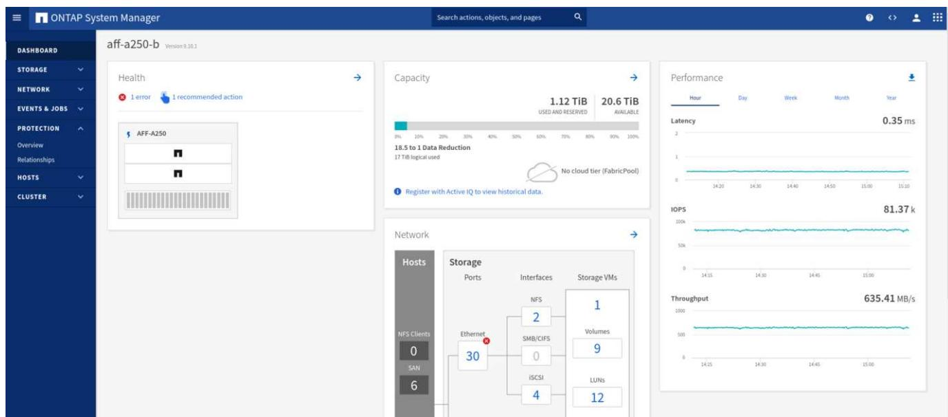
关闭站点 A 的存储控制器后，我们可以直观地验证站点 B 存储控制器 I/O 是否急剧增加，以便代表站点 A 提供额外的数据服务（请参见下图）。此外，IOMeter VM 的 GUI 还显示，尽管站点 A 存储集群发生中断，I/O 仍会继续。请注意，如果有其他数据存储库由不受 SM-BC 关系保护的 LUN 提供支持，则在发生存储灾难时，这些数据存储库将无法再访问。因此，必须评估各种应用程序数据的业务需求，并将其正确放置在受 SM-BC 关系保护的数据存储库中，以确保业务连续性。
