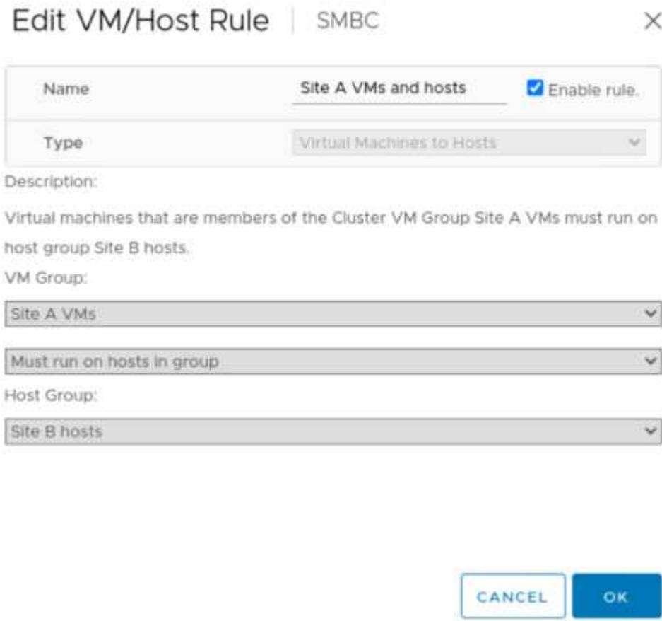
迁移虚拟机和存储服务后，您可以关闭服务器，存储控制器，磁盘架和交换机的电源，并执行所需的站点维护活动。完成站点维护并恢复 FlexPod 实例后，您可以更改 VM 的主机组关联性以返回到其原始站点。之后，您应将 " 必须在组中的主机上运行 " VM/ 主机站点关联性规则改回 " 应在组中的主机上运行 "，以便在发生灾难时，虚拟机可以在另一站点的主机上运行。在验证测试中，所有虚拟机均已成功迁移到另一站点，在对 SM-BC 关系执行故障转移后，数据服务继续正常运行。
