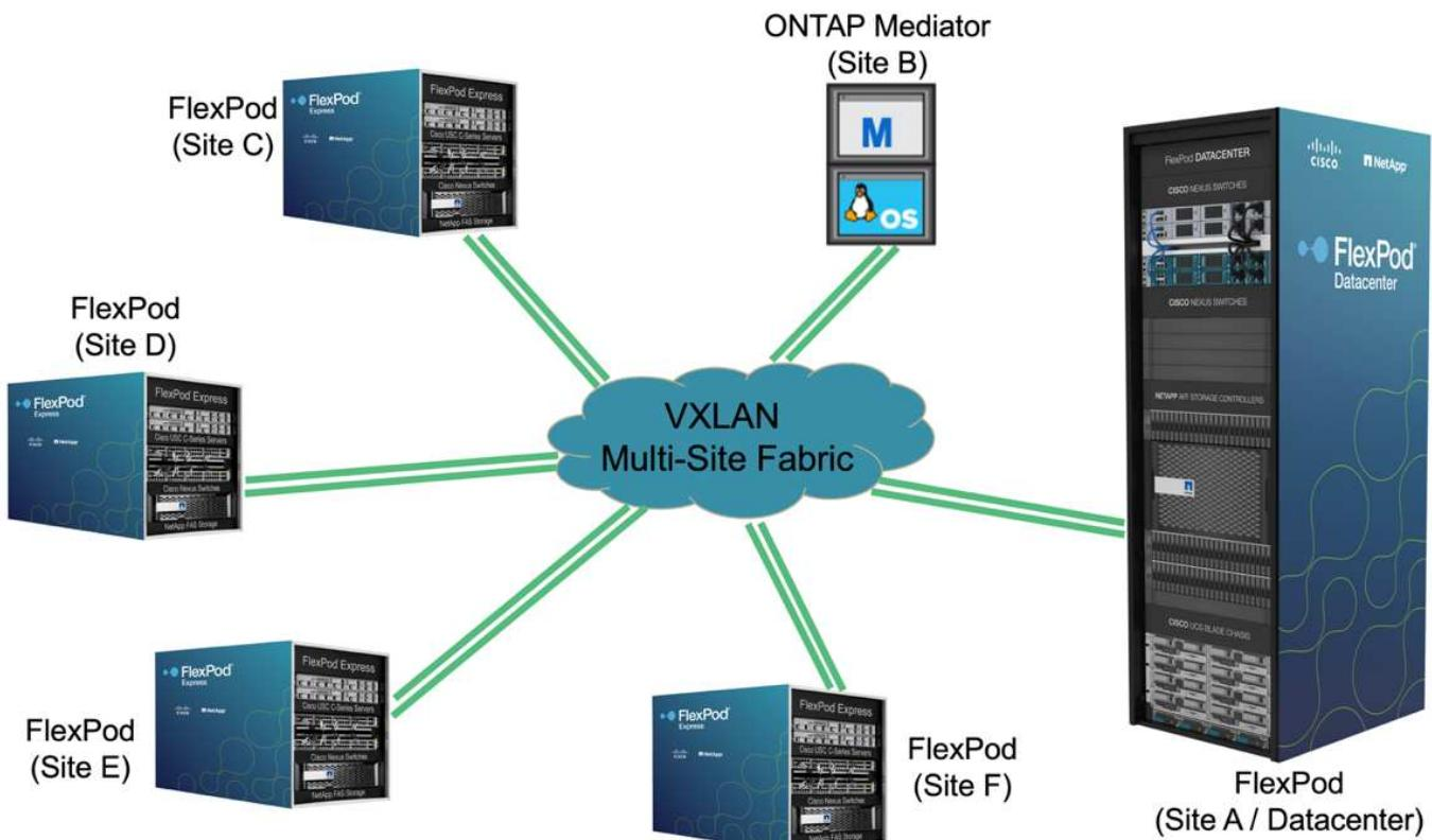
对于此部署模式，每个分支机构都与数据中心建立所需的 SM-BC 关系和一致性组。您必须考虑支持的 SM-BC 对象限制，以便整体一致性组关系和端点计数不会超过数据中心支持的最大值。
