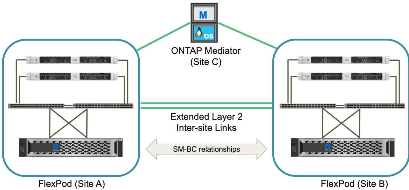
冗余计算，网络和存储组件通过组件之间的冗余连接互连在一起。这种高可用性设计可提供解决方案 故障恢复能力，并使 IT 能够承受单点故障情形。多站点设计和 ONTAP SM-BC 同步数据复制关系可提供业务关键型数据服务，尽管可能会发生单站点存储故障。
