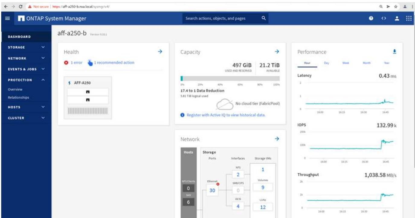
随着 I/O 从站点 A 透明地迁移到站点 B ，现在可以关闭站点 A 存储控制器以进行计划内维护。完成维护工作或测试并恢复站点 A 存储集群并使其正常运行后，请先检查并等待一致性组保护状态重新更改为同步 `，然后再执行故障转移，将故障转移 I/O 从站点 B 返回到站点 A 请注意，站点因维护或测试而关闭的时间越长，同步数据以及将一致性组返回到处于同步状态的`所需的时间就越长。
