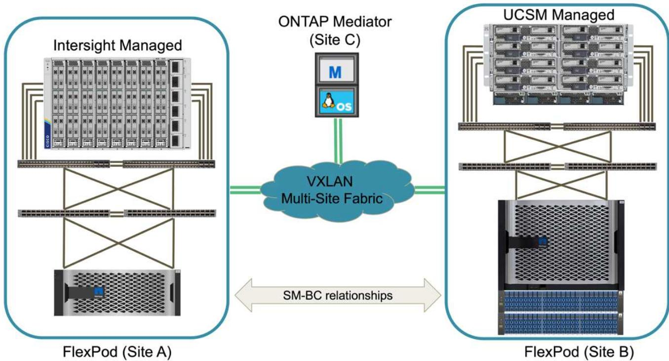
对于在城域中设有数据中心和多个分支机构的公司，这些公司都需要受到保护才能提供业务连续性，可以实施下图所示的 FlexPod SM-BC 部署拓扑，以保护关键应用程序和数据服务，使所有分支站点实现零 RPO 和接近零 RTO 目标。
