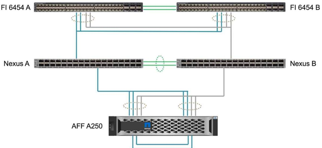
下表显示了每个站点的 Nexus 交换机和 AFF A250 存储控制器之间的连接。
