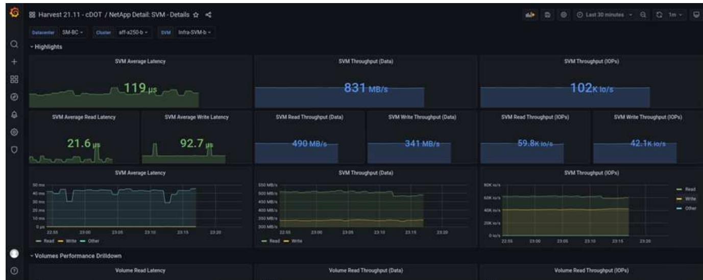
在引入灾难之前，站点 B 存储集群的 IOPS 约为 100,000 IOPS。然后，由于发生灾难，性能指标在图形的右侧急剧下降到零。由于站点 B 存储集群已关闭，因此在发生灾难后，无法从站点 B 集群收集任何数据。
