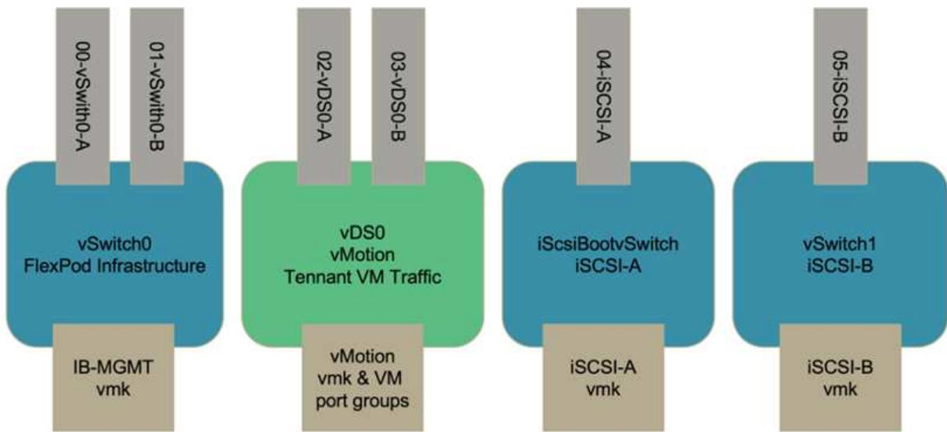
vSwitch0 是在 VMware ESXi 主机配置期间定义的，它包含用于管理的 FlexPod 基础架构管理 VLAN 和 ESXi 主机 VMkernel（VMK）端口。对于所需的任何关键基础架构管理虚拟机，还会在 vSwitch0 上放置一个基础架构管理虚拟机端口组。
