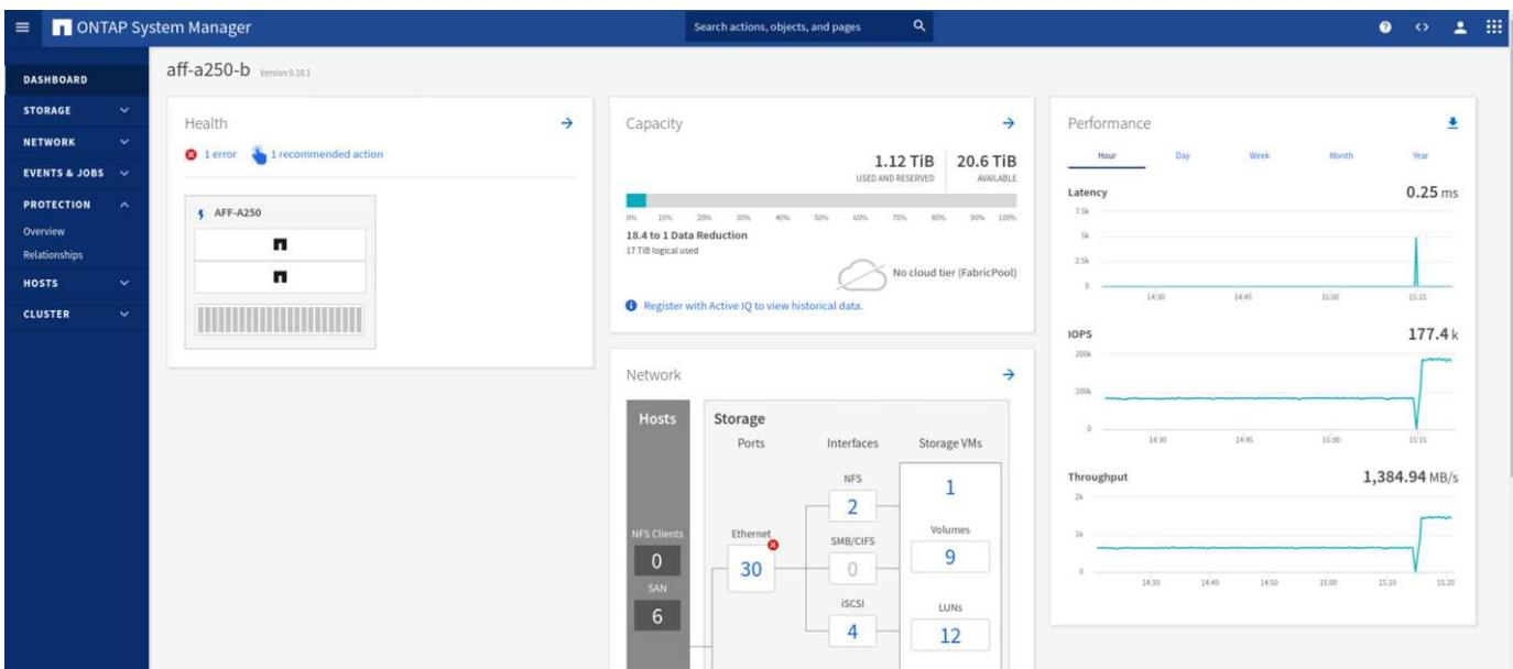
当站点 A 集群关闭时，一致组的关系会显示 不同步 状态，如下图所示。重新打开站点 A 存储控制器的电源后，存储集群将启动，站点 A 和站点 B 之间的数据同步将自动进行。
