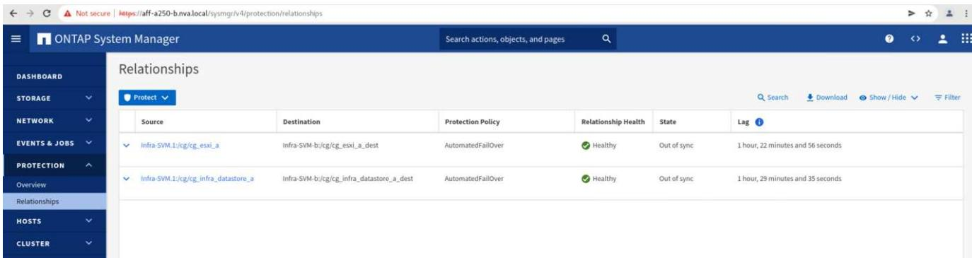
在将数据服务从站点 B 返回到站点 A 之前，您必须检查站点 A System Manager 并确保 SM-BC 关系正常运行且状态恢复同步。确认一致性组处于同步状态后，可以启动手动故障转移操作，将一致性组关系中的数据服务返回到站点 A
