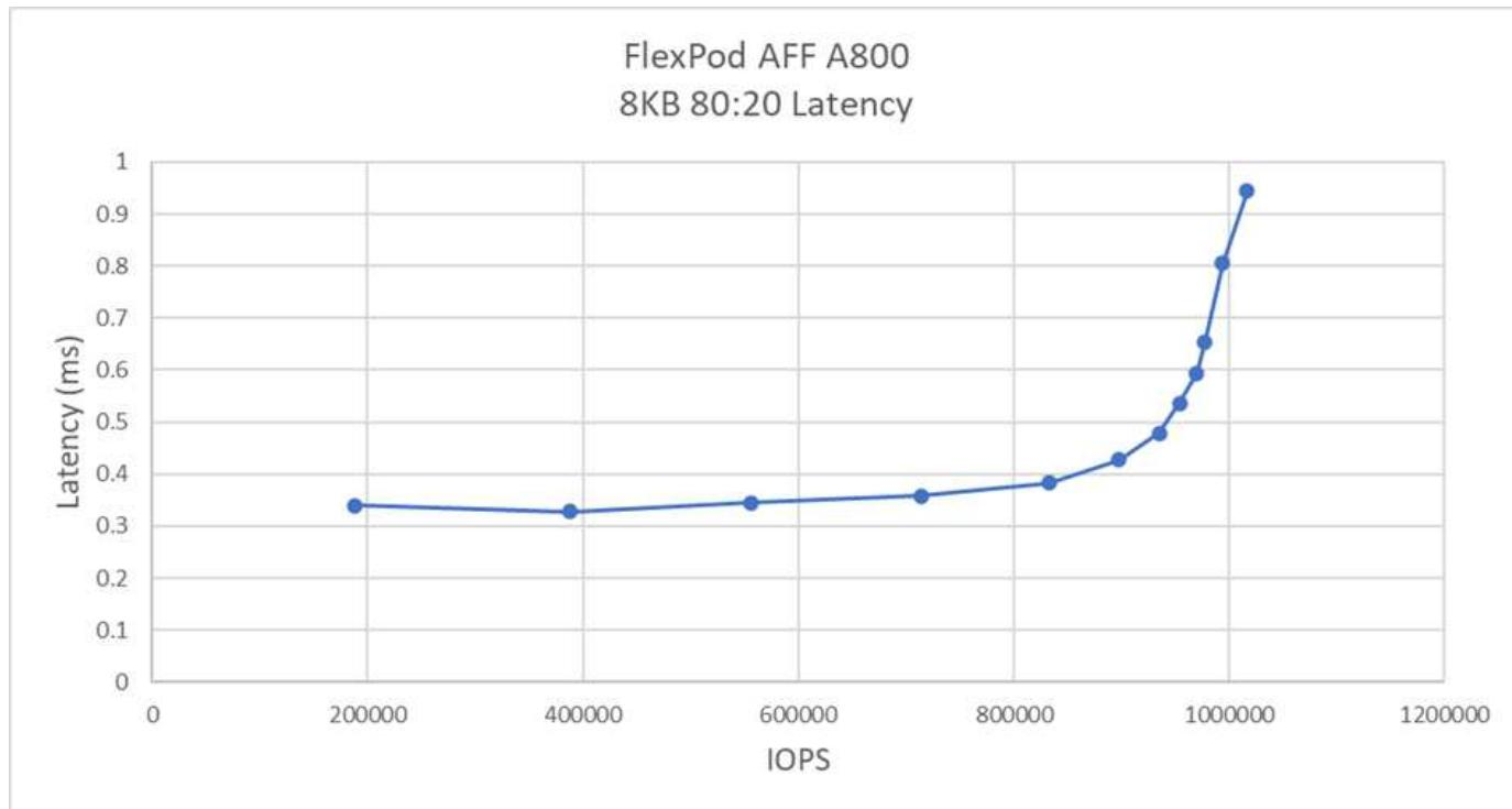
在我们的测试中，我们发现系统实现了超过 100 万次的 IOPS，同时服务器端延迟仅保持在 1 毫秒以下。
