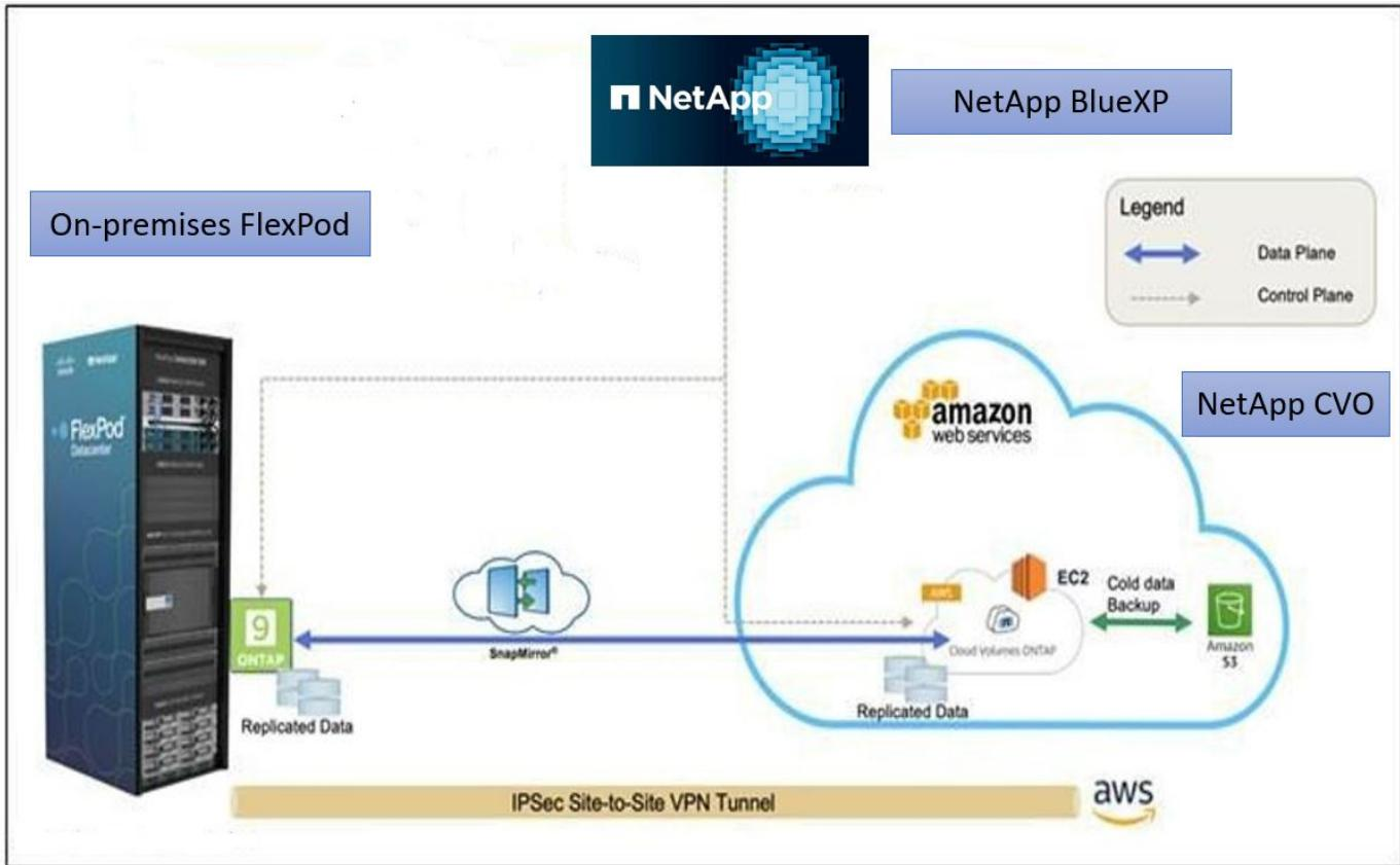
控制平面和数据平面会在端点之间清晰地指示。通过利用安全的站点到站点VPN连接、数据平面在FlexPod 的纯闪存FAS 上运行的ONTAP 实例与AWS中的NetApp CVO实例之间运行。将医疗保健工作负载数据从内部FlexPod 数据中心复制到NetApp Cloud Volumes ONTAP 时、会通过NetApp SnapMirror复制来处理。此外、此解决方案 还支持将NetApp CVO实例中的冷数据备份和分层到AWS S3。
