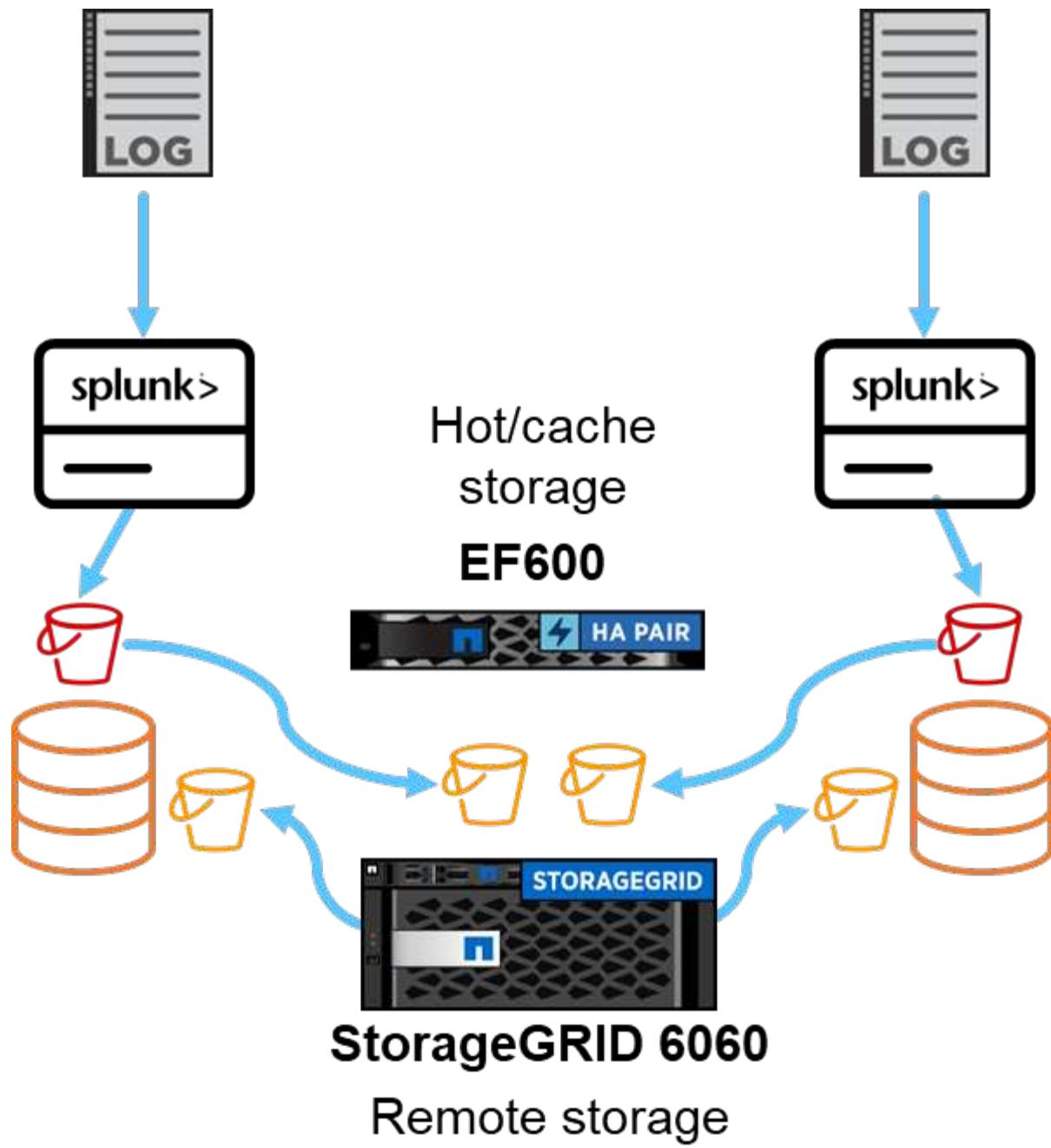
我们使用 EF600 作为热/缓存存储，使用StorageGRID 6060 作为远程存储。我们使用以下架构进行性能验证。我们使用了两个搜索头、四个重型转发器将数据转发到索引器、七个 Splunk 事件生成器（Eventgens）来生成实时数据，以及 18 个索引器来存储数据。
