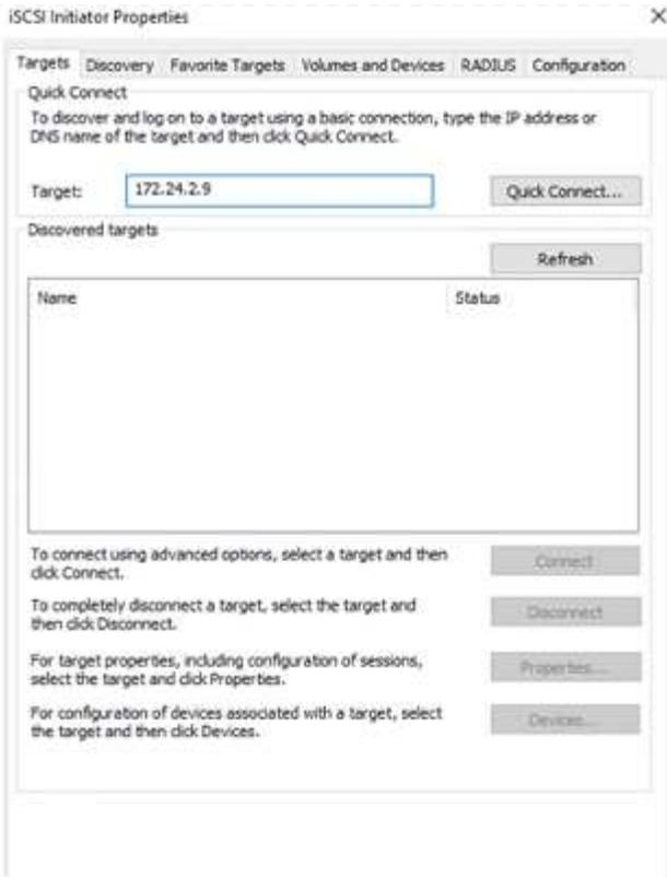
存储虚拟机 (SVM) 上的 LUN 对于 Windows 主机来说显示为磁盘。主机不会自动发现任何新添加的磁盘。通过完成以下步骤触发手动重新扫描以发现磁盘：
