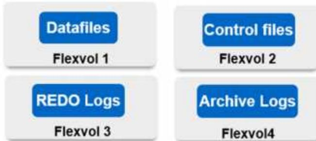
对于较小的 Oracle 数据库，SnapCenter支持共享存储布局，您可以在同一个存储卷或 LUN 上托管多个数据库或部分数据库。作为此布局的示例，您可以在 +DATA ASM 磁盘组或卷组上托管所有数据库的数据文件。其余文件（重做、存档日志和控制文件）可以托管在另一个专用磁盘组或卷组（LVM）上。此类部署场景如下所示。
