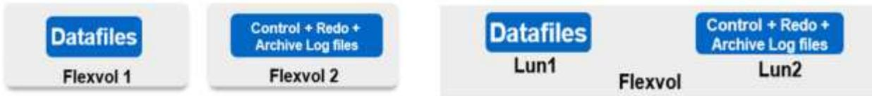
对于对延迟敏感的关键任务工作负载，应将专用存储卷部署到不同类型的 Oracle 文件，以实现最佳延迟。对于大型数据库，每个卷应为数据文件分配多个 LUN（NetApp建议最多八个）。
