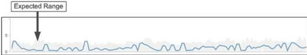
在此示例中、卷的延迟预期范围(以灰色显示)最低为每操作0毫秒(毫秒/操作)、最高为5毫秒/操作。如果由于网络流量间歇性峰值或集群组件上的争用、实际延迟(以蓝色显示)突然增加到10毫秒/操作、则该延迟将高于预期范围并超过性能阈值。
