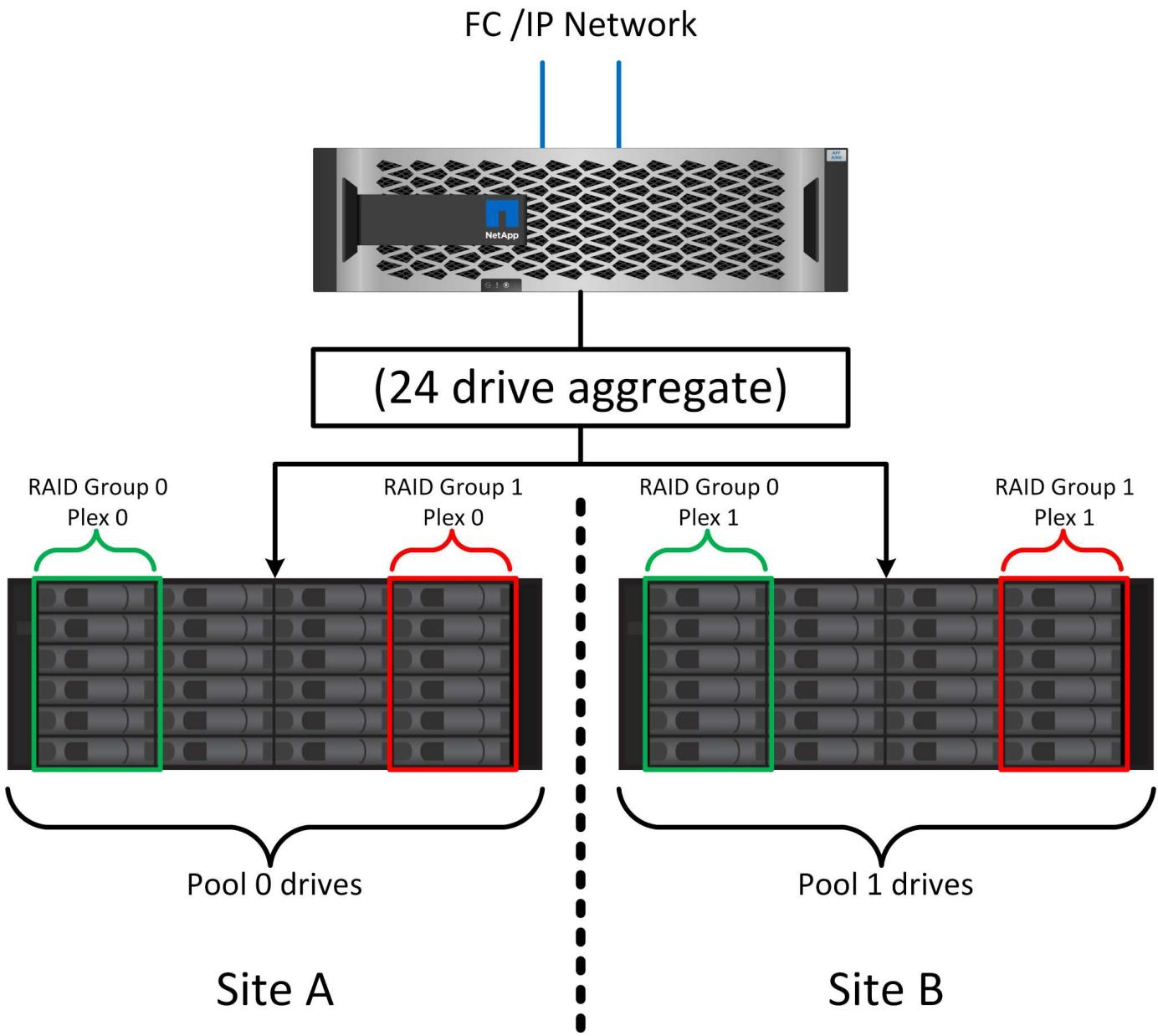
上图显示了一个示例SyncMirror配置。在控制器上创建了一个包含24个驱动器的聚合、其中12个驱动器来自站点A上分配的磁盘架、12个驱动器来自站点B上分配的磁盘架。这些驱动器被分组为两个镜像RAID组。RAID组0在站点A上包含一个6驱动器丛、该丛镜像到站点B上的一个6驱动器丛。同样、RAID组1在站点A上包含一个6驱动器丛、该丛镜像到站点B上的6驱动器丛。
