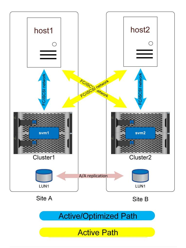
在正常操作下、所有IO均为本地IO。读取和写入操作由本地存储阵列提供。当然、在确认写入IO之前、本地控制器也需要将其复制到远程系统、但所有读取IO都将在本地进行处理、并且不会通过遍历站点间的SAN链路而产生额外延迟。
