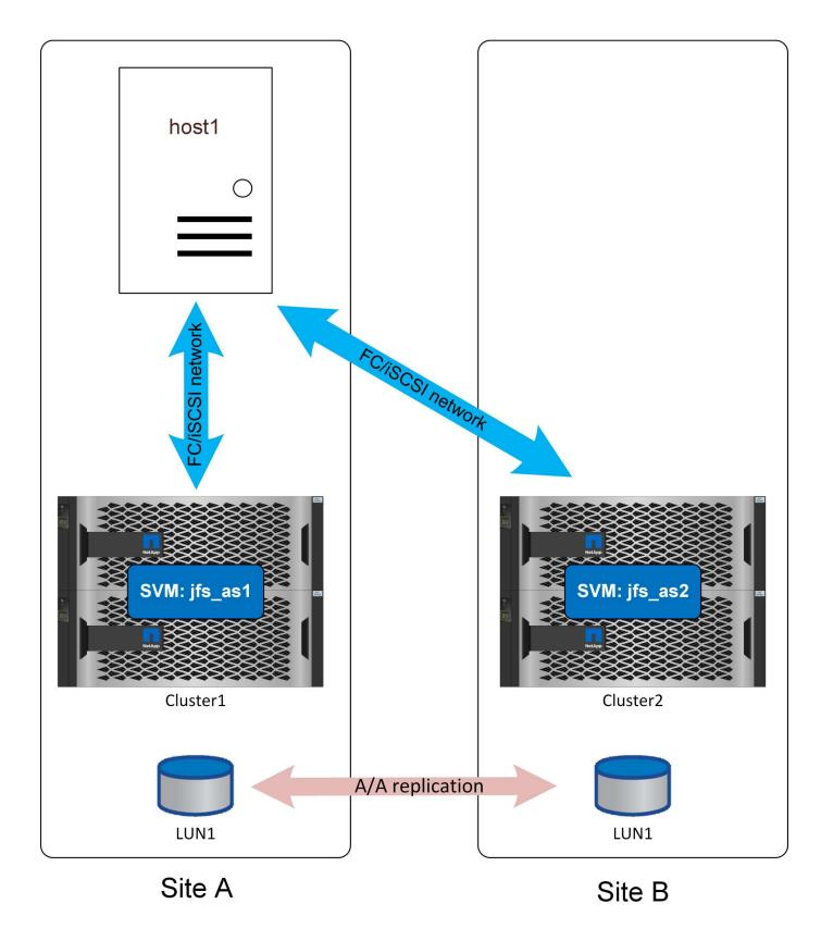
使用统一访问时、任一站点的存储故障都不会中断数据库操作。当然、如果包含数据库服务器的站点发生完全故障、则会导致中断。
