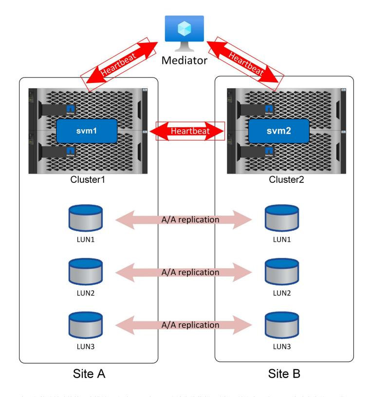
自动化故障转移的第一大挑战是脑裂问题、如果两个站点彼此断开连接、就会出现该问题。应该发生什么?您不希望让两个不同的站点将自己指定为数据的无故障副本、但单个站点如何区分实际丢失相对站点与无法与相反站点通信之间的区别?
