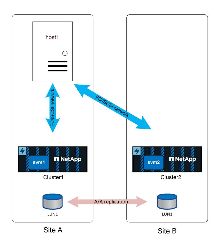
使用统一访问时、任一站点的存储故障都不会中断数据库操作。当然、如果包含数据库服务器的站点发生完全故障、则会导致中断。
