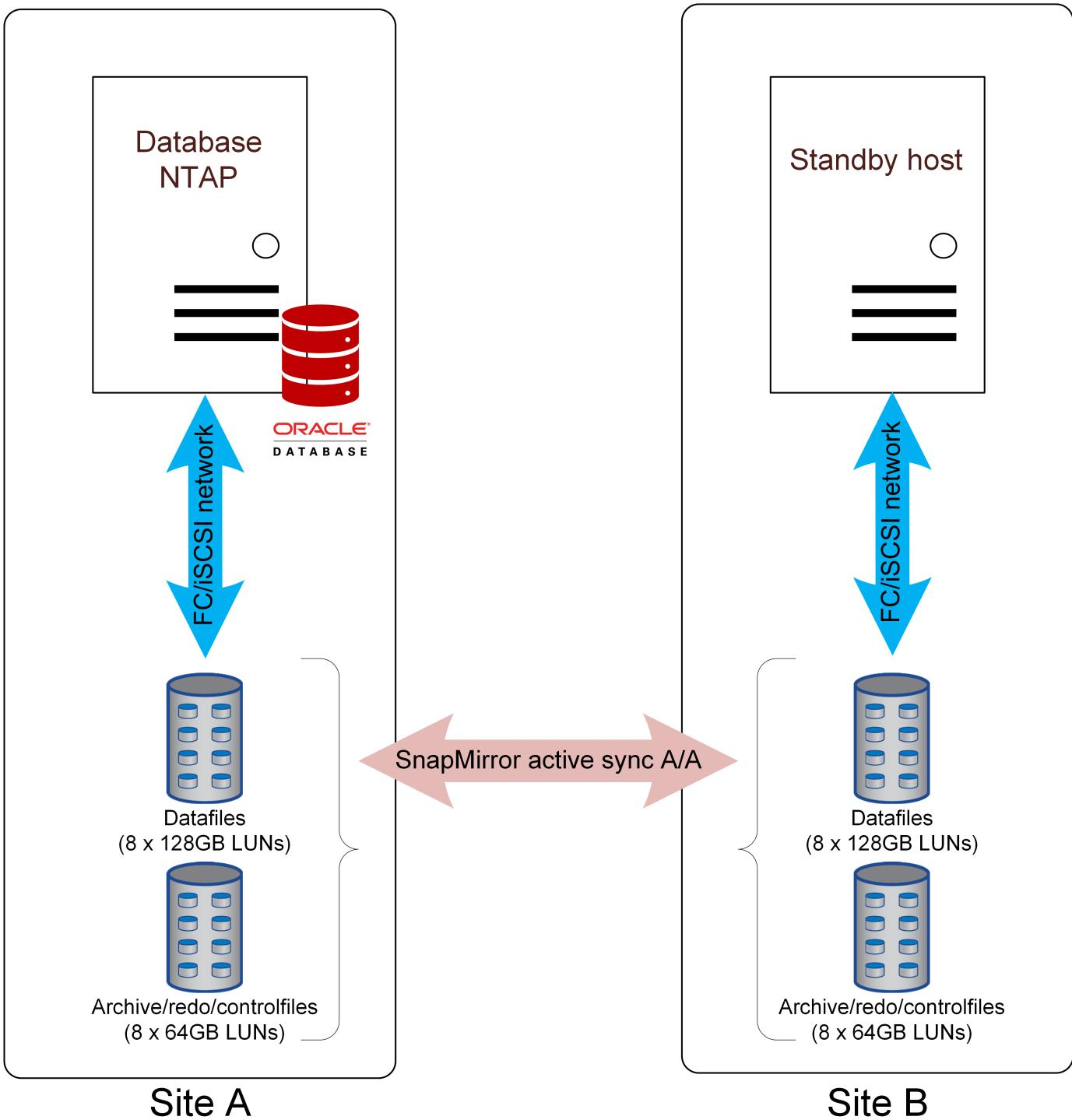
使用预配置的操作系统进行故障转移
