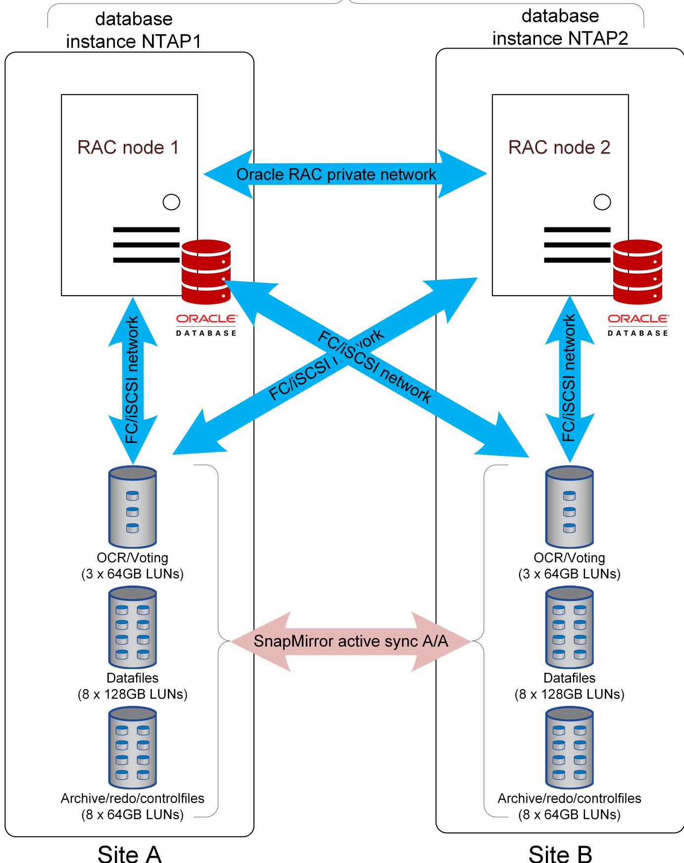
每个主机都可以使用两个存储系统上的所有操作路径。这样、每个主机就可以利用两个集群(而不仅仅是一个集群)的性能潜能、从而显著提高性能。
