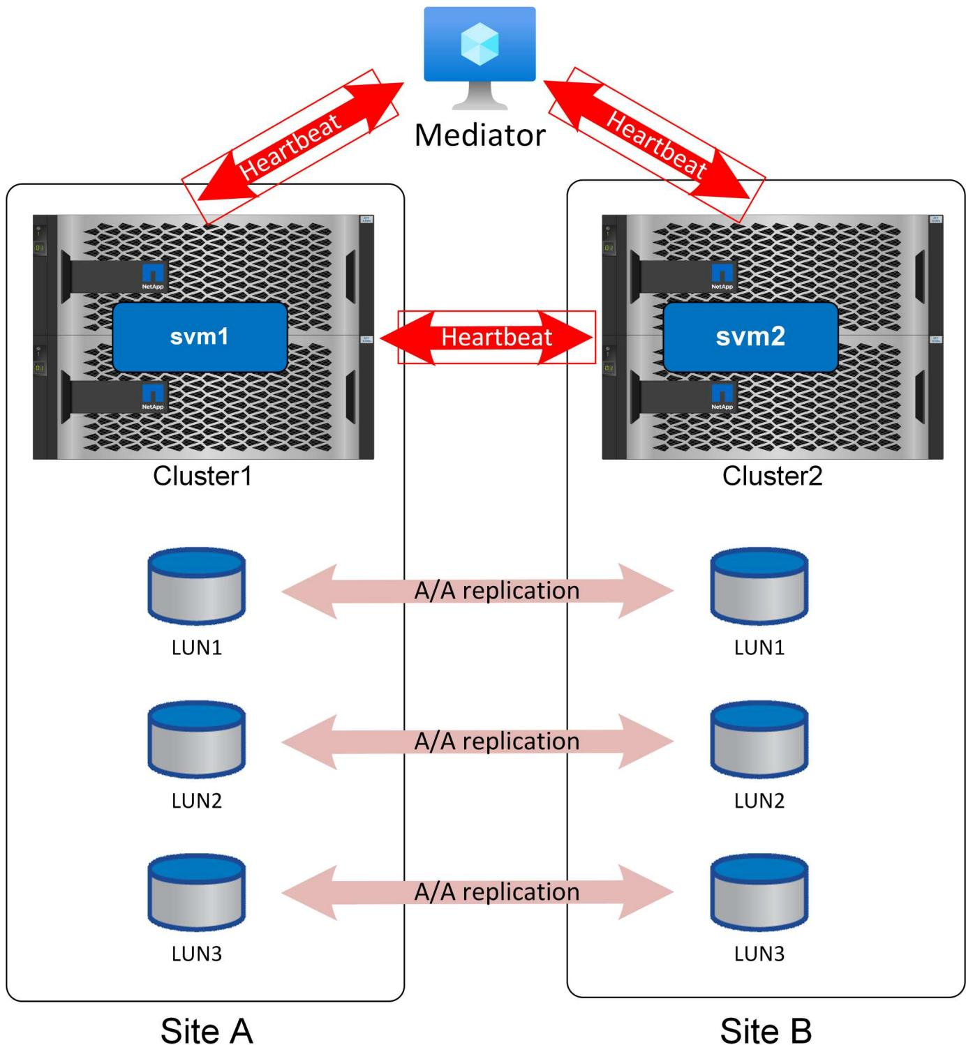
自动化故障转移的第一大挑战是脑裂问题、如果两个站点彼此断开连接、就会出现该问题。应该发生什么？您不希望让两个不同的站点将自己指定为数据的无故障副本、但单个站点如何区分实际丢失相对站点与无法与相反站点通信之间的区别？
