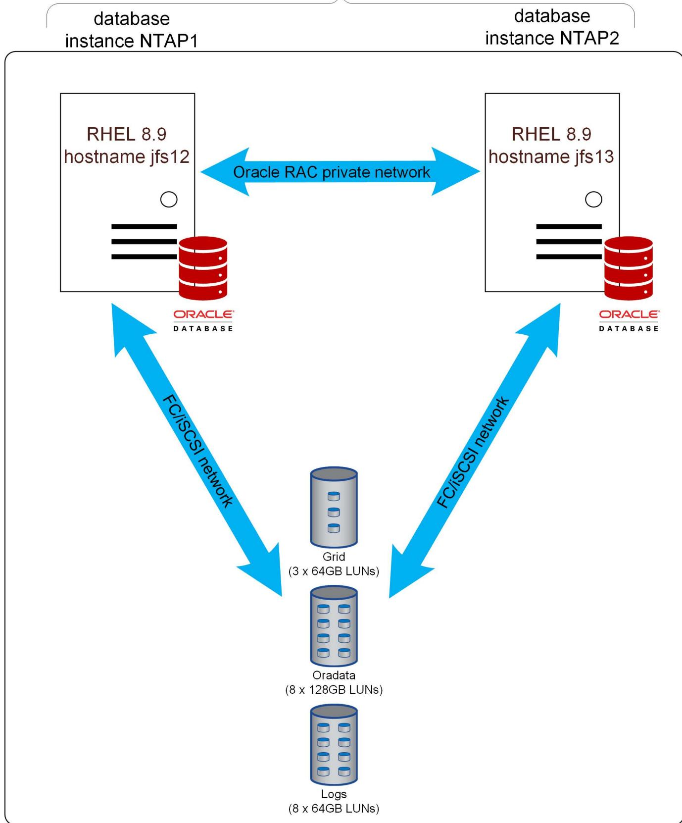
没有主副本或镜像副本。从逻辑上讲、每个LUN只有一个副本、并且该LUN可在两个不同存储系统上的SAN路径上使用。从主机角度来看、不会发生存储故障转移、而是会发生路径更改。各种故障事件可能会导致LUN的某些路径丢失、而其他路径仍保持联机状态。SnapMirror主动同步可确保在所有操作路径中提供相同的数据。
