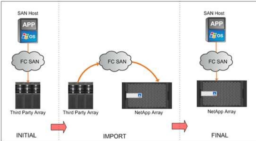
此图显示了 FLI 联机数据迁移。主机已连接到现在托管新 LUN 的 NetApp 控制器。然后，可以在导入期间恢复并继续执行主机操作。
