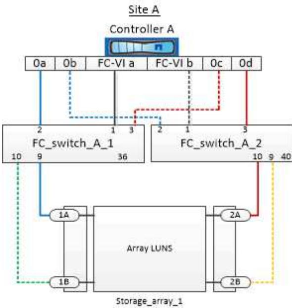
使用阵列 LUN 的双节点 MetroCluster 配置的延伸型和光纤连接型两种配置的存储阵列端口和 FC 交换机端口之间的连接都类似。
