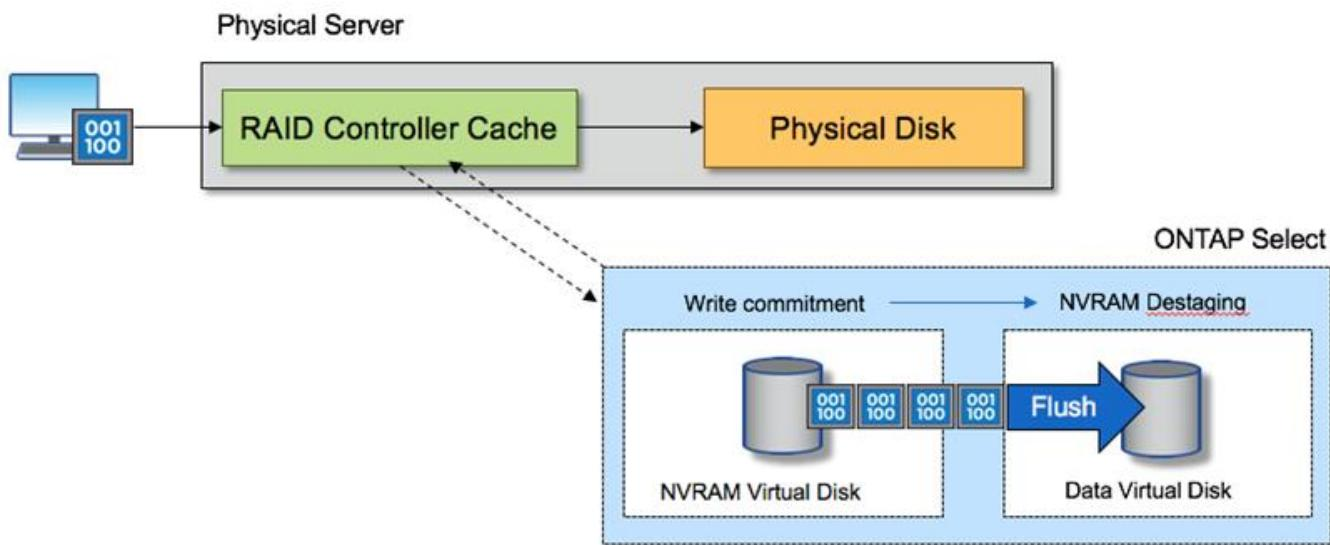
**i** NVRAM 分区将在其自己的 VMDK 上分隔。该 VMDK 使用 ESX 6.5 或更高版本中提供的 vNVME 驱动程序进行连接。对于使用软件 RAID 的 ONTAP Select 安装来说，此更改最重要，因为这些安装不会从 RAID 控制器缓存中受益。
