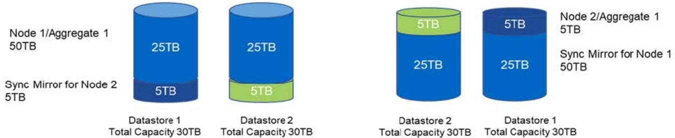
容量添加操作期间使用的最大 VMDK 大小为 16 TB。集群创建操作期间使用的最大 VMDK 大小仍为 8 TB。ONTAP Deploy 会根据您的配置（单节点或多节点集群）以及要添加的容量创建大小正确的 VMDK。但是，在集群创建操作期间，每个 VMDK 的最大大小不应超过 8 TB，在存储添加操作期间，最大大小不应超过 16 TB。
