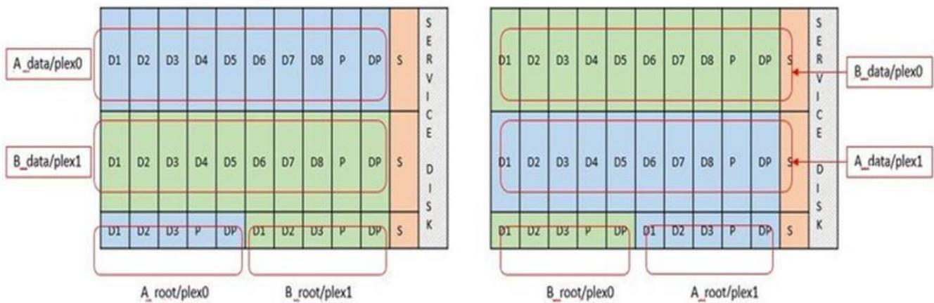
ONTAP 软件 RAID 支持以下 RAID 类型： RAID 4， RAID-DP 和 RAID-TEC。这些 RAID 构造与 FAS 和 AFF 平台使用的 RAID 构造相同。对于根配置， ONTAP Select 仅支持 RAID 4 和 RAID-DP。对数据聚合使用 RAID-TEC 时，整体保护为 RAID-DP。ONTAP Select HA 使用无共享架构将每个节点的配置复制到另一节点。这意味着每个节点都必须存储其根分区及其对等方根分区的副本。由于数据磁盘具有一个根分区，因此数据磁盘的最小数量将因 ONTAP Select 节点是否属于 HA 对而异。
