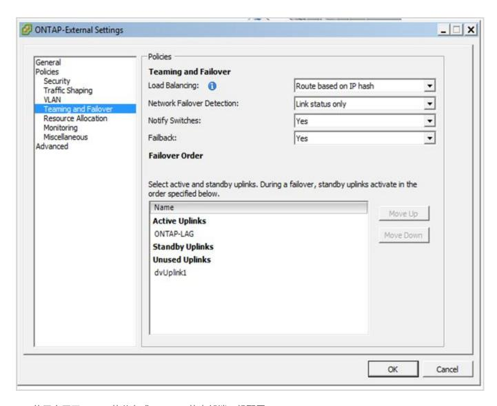
• 使用启用了 LACP 的分布式 vSwitch 的内部端口组配置 \*
