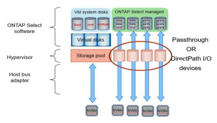
系统磁盘( VMDK )位于同一个数据存储库中,并且位于同一个物理磁盘上。虚拟 NVRAM 磁盘需要一个快速 且持久的介质。因此,仅支持 NVMe 和 SSD 类型的数据存储库。在使用 NVMe 驱动器存储数据时,出于性能 原因,系统磁盘也应是 NVMe 设备。在全 NVMe 配置中,最好使用 Intel Optane 卡作为系统磁盘。
