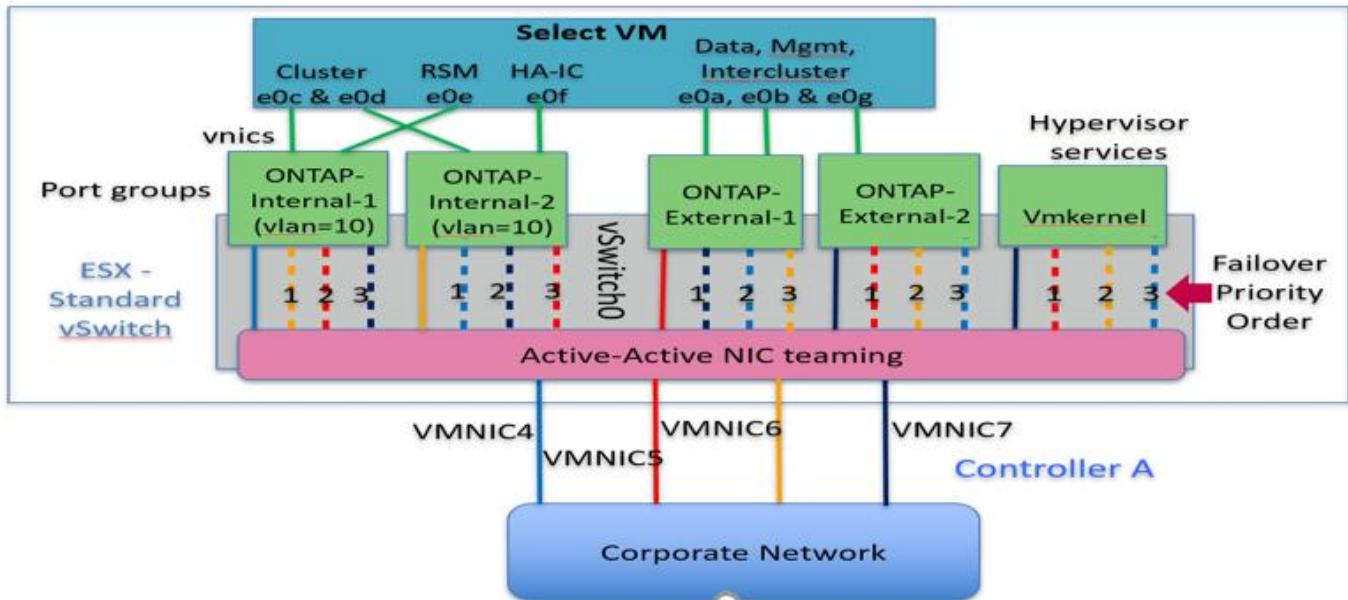
端口在备用列表中的顺序非常重要。下表提供了四个端口组之间的物理端口分布示例。
