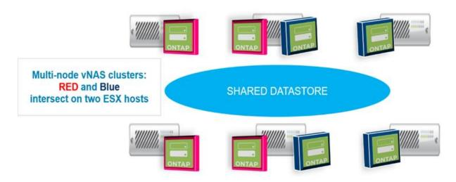
部署后,可以在主机之间迁移 ONTAP Select 节点。这可能会导致配置不是最佳配置,并且不受支持,因为同一集群中的两个或更多 ONTAP Select 节点共享同一个底层主机。NetApp 建议手动创建 VM 反关联性规则,以便 VMware 自动在同一集群的节点之间保持物理隔离,而不仅仅是同一 HA 对中的节点。
