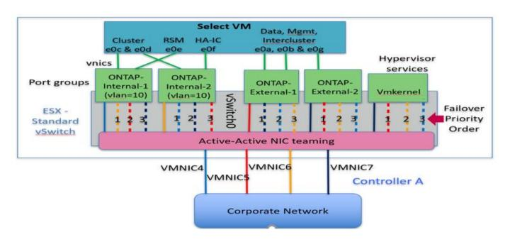
端口在备用列表中的顺序非常重要。下表提供了四个端口组之间的物理端口分布示例。
