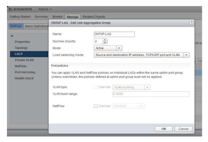
• 使用已启用 LACP 的分布式 vSwitch 的外部端口组配置 \*
