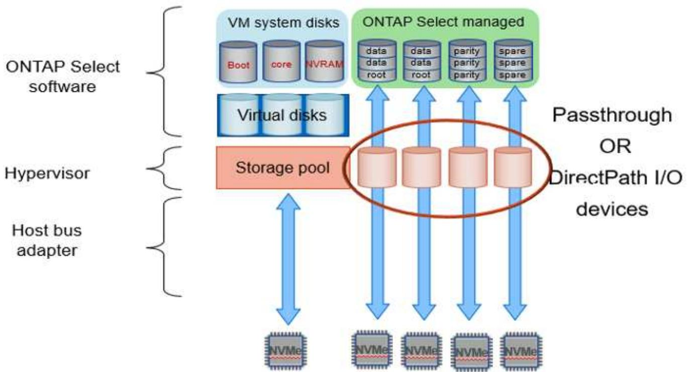
系统磁盘（VMDK）位于同一个数据存储库中，并且位于同一个物理磁盘上。虚拟 NVRAM 磁盘需要一个快速且持久的介质。因此，仅支持 NVMe 和 SSD 类型的数据存储库。在使用 NVMe 驱动器存储数据时，出于性能原因，系统磁盘也应是 NVMe 设备。在全 NVMe 配置中，最好使用 Intel Optane 卡作为系统磁盘。
