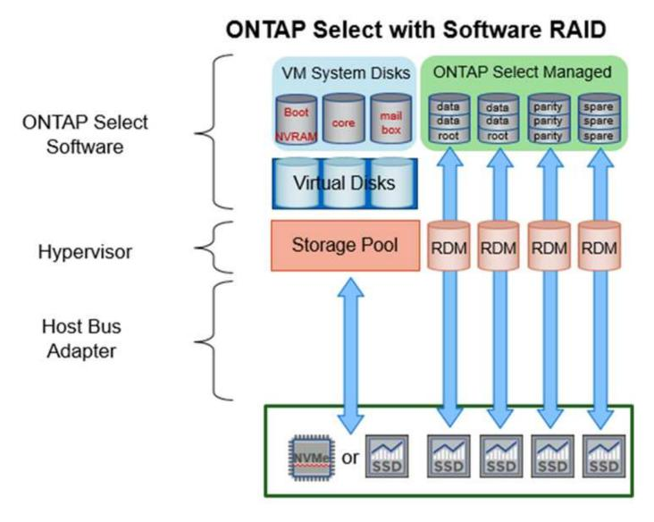
系统磁盘( VMDK )位于同一个数据存储库中,并且位于同一个物理磁盘上。虚拟 NVRAM 磁盘需要一个快速 且持久的介质。因此,仅支持 NVMe 和 SSD 类型的数据存储库。
