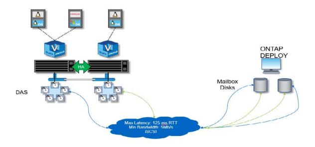
双节点 ONTAP Select 集群由一个 HA 对和一个调解器组成。在 HA 对中,每个集群节点上的数据聚合都会进行同步镜像,如果发生故障转移,则不会丢失任何数据。
