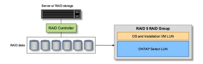
通过从与 ONTAP Select 相同的 RAID 组配置操作系统 LUN ,虚拟机管理程序操作系统(以及也从该存储配置的任何客户端虚拟机)可以从 RAID 保护中受益。此配置可防止单驱动器故障导致整个系统停机。
