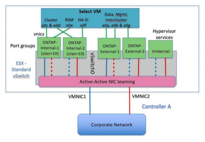
使用两个物理端口( 10 Gb 或更少)时,每个端口组应配置一个活动适配器和一个备用适配器,使其彼此相对。内部网络仅适用于多节点 ONTAP Select 集群。对于单节点集群,可以将这两个适配器配置为外部端口组中的活动适配器。
