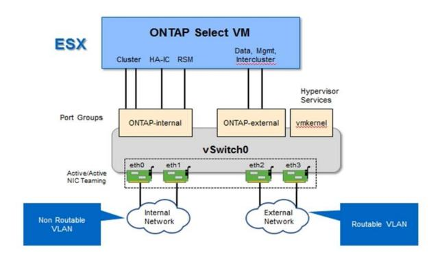
在不同物理 NIC 之间隔离内部和外部流量可防止因对网络资源的访问不足而导致系统出现延迟。此外,通过 NIC 绑定进行聚合可确保单个网络适配器出现故障不会阻止 ONTAP Select 集群节点访问相应的网络。
