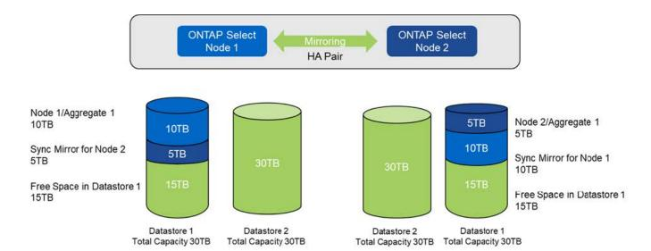
节点 1 上的两个额外的存储添加操作会占用数据存储库 1 的其余部分和数据存储库 2 的一部分(使用容量上限)。第一个 storage-add 操作会占用数据存储库 1 中剩余的 15 TB 可用空间。下图显示了第二个 storage-add 操作的结果。此时,节点 1 管理着 50 TB 的活动数据,而节点 2 管理着原始 5 TB 的活动数据。
