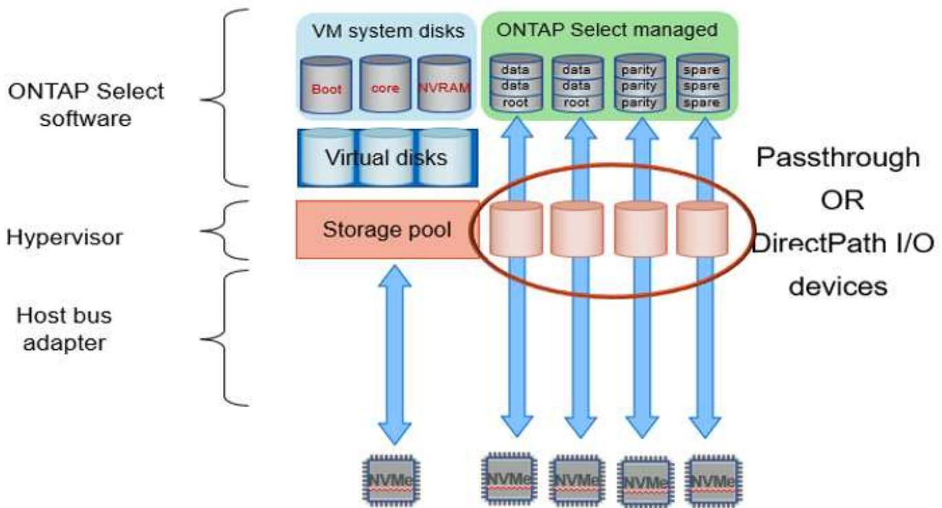
系统磁盘 (VMDK) 位于同一数据存储区和同一物理磁盘上。虚拟NVRAM磁盘需要快速且耐用的介质。因此，仅支持 NVMe 和 SSD 类型的数据存储区。使用 NVMe 驱动器存储数据时，出于性能考虑，系统磁盘也应为 NVMe 设备。在全 NVMe 配置中，英特尔傲腾卡是系统磁盘的理想选择。
