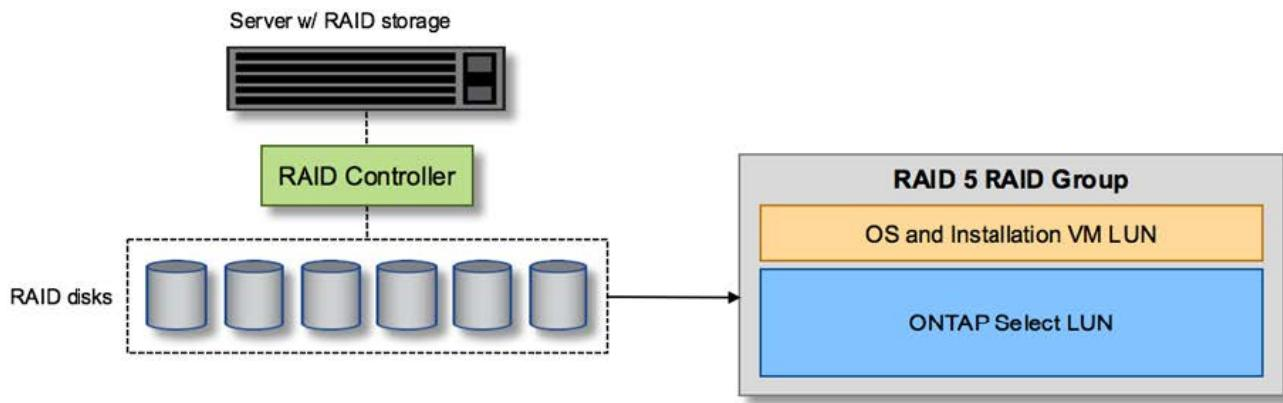
通过与ONTAP Select相同的 RAID 组配置操作系统 LUN，虚拟机管理程序操作系统（以及同样从该存储配置的任何客户端虚拟机）可受益于 RAID 保护。此配置可防止单个驱动器故障导致整个系统崩溃。
