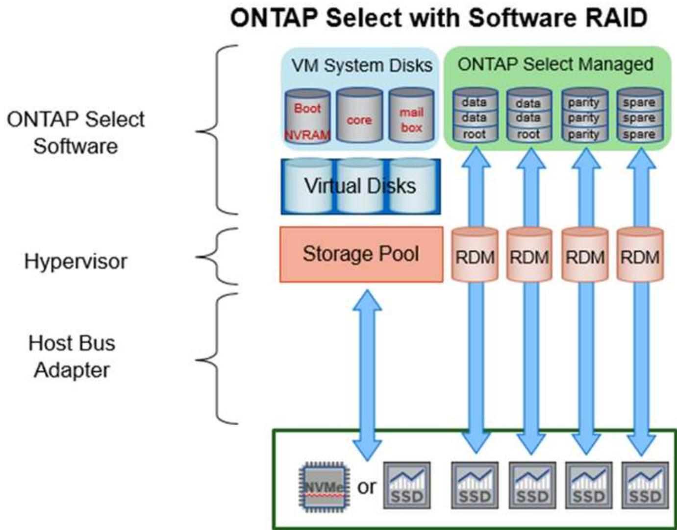
系统磁盘 (VMDK) 位于同一数据存储区和同一物理磁盘上。虚拟 NVRAM 磁盘需要快速且耐用的介质。因此，仅支持 NVMe 和 SSD 类型的数据存储区。
