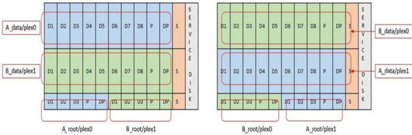
ONTAP软件 RAID 支持以下 RAID 类型：RAID 4、RAID-DP 和 RAID-TEC。这些是FAS和AFF平台使用的相同 RAID 结构。对于根配置，ONTAP Select仅支持 RAID 4 和 RAID-DP。当使用RAID-TEC进行数据聚合时，整体保护是 RAID-DP。ONTAPONTAP Select HA 使用无共享架构，将每个节点的配置复制到另一个节点。这意味着每个节点必须存储其根分区及其对等节点根分区的副本。由于数据磁盘只有一个根分区，因此最低数据磁盘数量将取决于ONTAP Select节点是否属于 HA 对。
