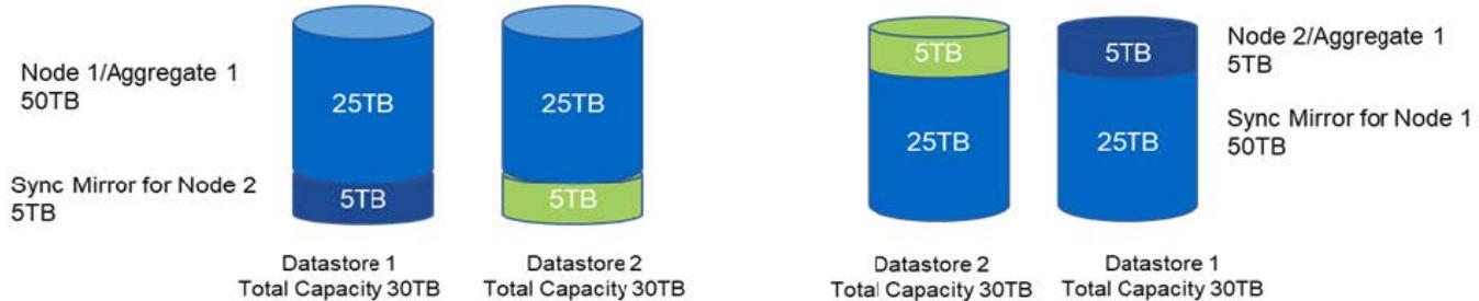
容量添加操作期间使用的最大 VMDK 大小为 16 TB。集群创建操作期间使用的最大 VMDK 大小仍然为 8 TB。ONTAP ONTAP会根据您的配置（单节点或多节点集群）和要添加的容量创建正确大小的 VMDK。但是，集群创建操作期间每个 VMDK 的最大大小不应超过 8 TB，存储添加操作期间每个 VMDK 的最大大小不应超过 16 TB。
