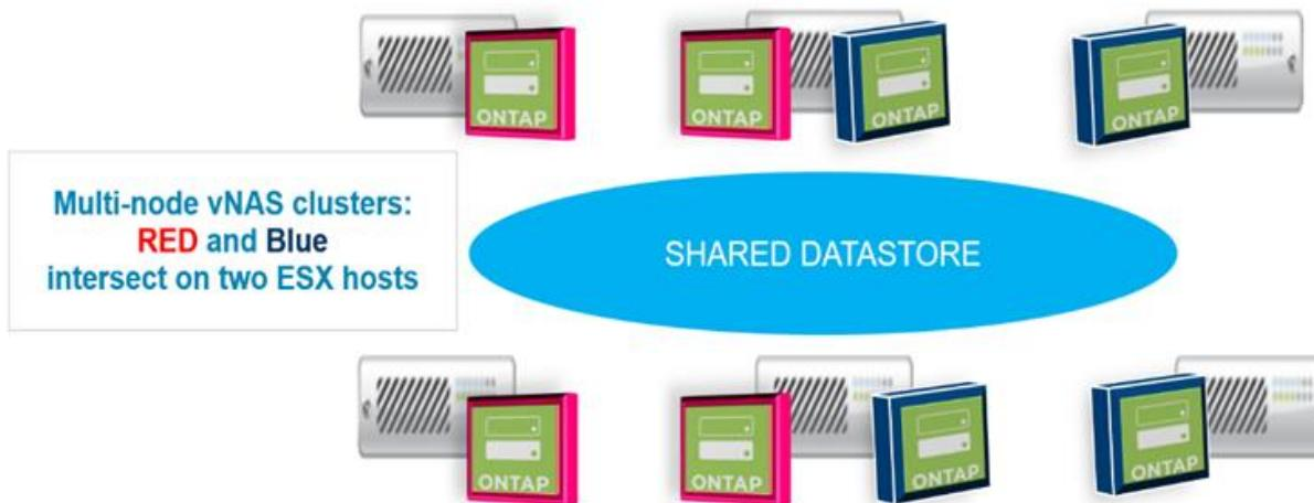
部署后，ONTAP Select节点可以在主机之间迁移。这可能会导致配置不理想且不受支持，因为同一集群中的两个或多个ONTAP Select节点共享同一底层主机。NetApp建议手动创建虚拟机反关联性规则，以便 VMware 自动维护同一集群中节点之间的物理隔离，而不仅仅是同一 HA 对中的节点之间的物理隔离。
