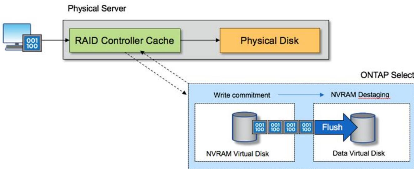
**NVRAM分区在其自己的 VMDK 上独立存在。该 VMDK 使用 ESX 6.5 或更高版本中提供的 vNVME 驱动程序进行连接。此更改对于使用软件 RAID 的ONTAP Select安装最为重要，因为此类安装无法从 RAID 控制器缓存中获益。**
