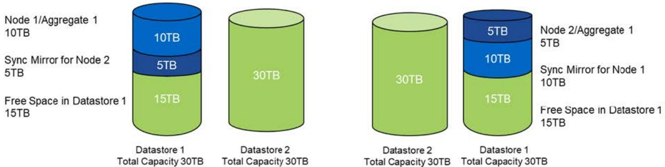
节点 1 上的另外两次存储添加操作占用了数据存储 1 的剩余空间以及数据存储 2 的一部分空间（使用容量上限）。第一次存储添加操作占用了数据存储 1 中剩余的 15 TB 可用空间。下图显示了第二次存储添加操作的结果。此时，节点 1 管理着 50 TB 的活跃数据，而节点 2 则拥有原来的 5 TB。
