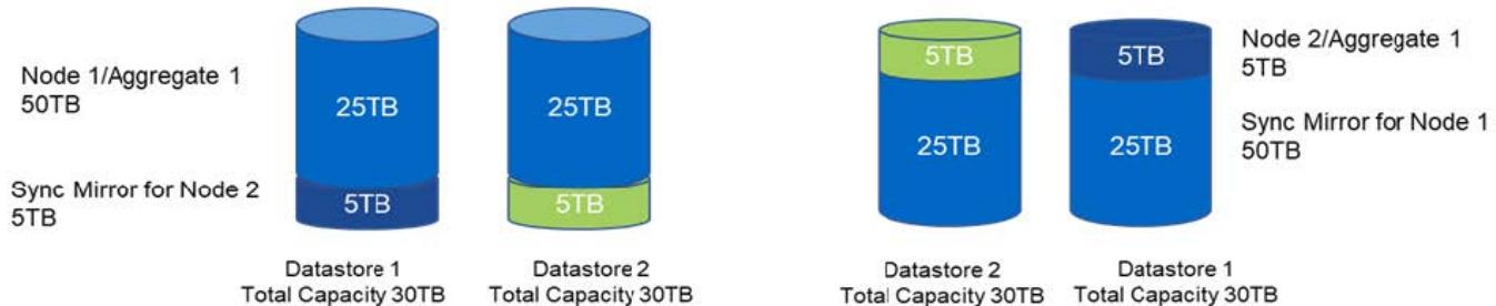
容量添加操作期间使用的最大 VMDK 大小为 16TB。集群创建操作期间使用的最大 VMDK 大小仍为 8TB。ONTAP Deploy 根据您的配置（单节点或多节点集群）和添加的容量创建正确大小的 VMDK。但是，每个 VMDK 的最大大小在集群创建操作期间不应超过 8TB，在存储添加操作期间不应超过 16TB。
