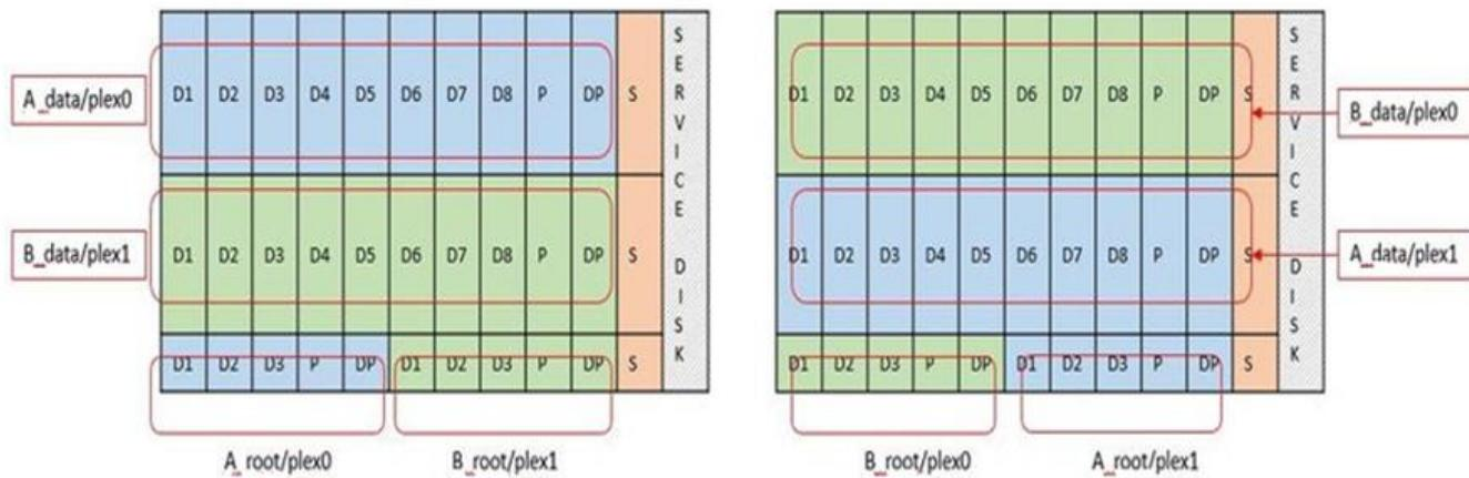
ONTAP 软件 RAID 支持以下 RAID 类型：RAID 4、RAID-DP 和 RAID-TEC。这些是 FAS 和 AFF 平台使用的相同 RAID 结构。对于根配置，ONTAP Select 仅支持 RAID 4 和 RAID-DP。当使用 RAID-TEC 进行数据聚合时，整体保护是 RAID-DP。ONTAP ONTAP Select HA 使用无共享架构，将每个节点的配置复制到另一个节点。这意味着每个节点都必须存储其根分区及其对等节点根分区的副本。数据磁盘有一个根分区。这意味着数据磁盘的最小数量取决于 ONTAP Select 节点是否属于 HA 对。
