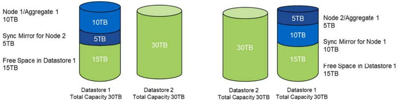
节点 1 上的两个额外的存储添加操作会占用数据存储库 1 的其余部分和数据存储库 2 的一部分（使用容量上限）。第一个 storage-add 操作会占用数据存储库 1 中剩余的 15 TB 可用空间。下图显示了第二个 storage-add 操作的结果。此时，节点 1 管理着 50 TB 的活动数据，而节点 2 管理着原始 5 TB 的活动数据。
