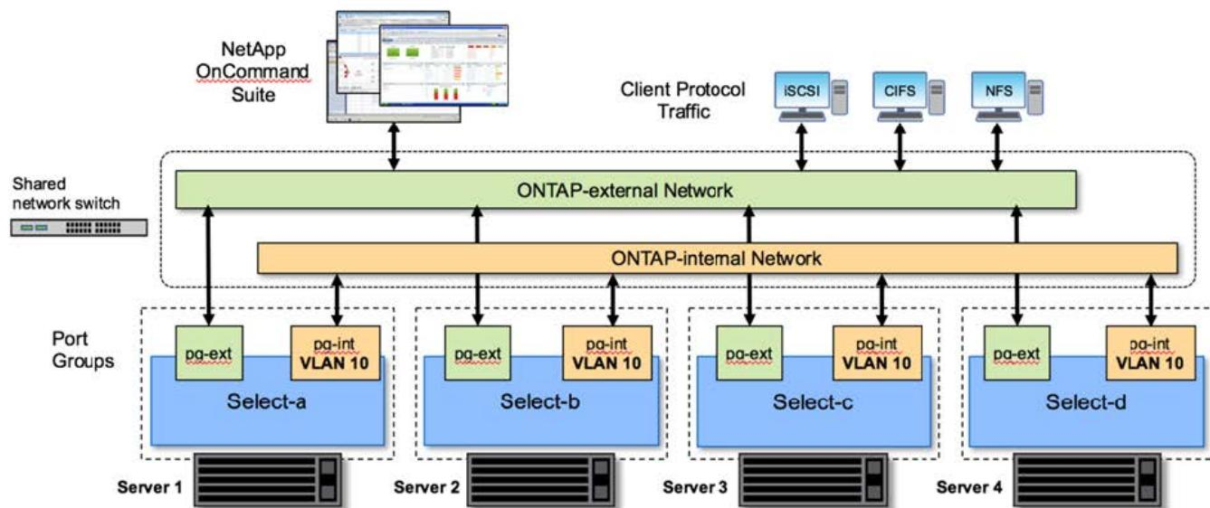
每个 ONTAP Select VM 都包含七个虚拟网络适配器，这些适配器作为一组七个网络端口（ e0a 到 e0g ）提供给 ONTAP 。虽然 ONTAP 将这些适配器视为物理 NIC ，但它们实际上是虚拟的，并通过虚拟化网络层映射到一组物理接口。因此，每个托管服务器不需要六个物理网络端口。
