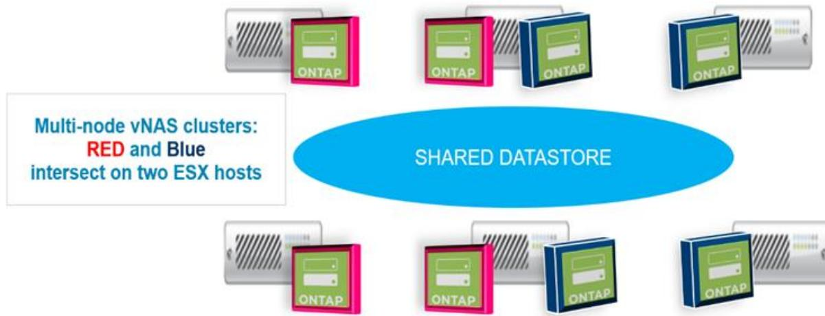
部署后，可以在主机之间迁移 ONTAP Select 节点。这可能会导致配置不是最佳配置，并且不受支持，因为同一集群中的两个或更多 ONTAP Select 节点共享同一个底层主机。NetApp 建议手动创建 VM 反关联性规则，以便 VMware 自动在同一集群的节点之间保持物理隔离，而不仅仅是同一 HA 对中的节点。
