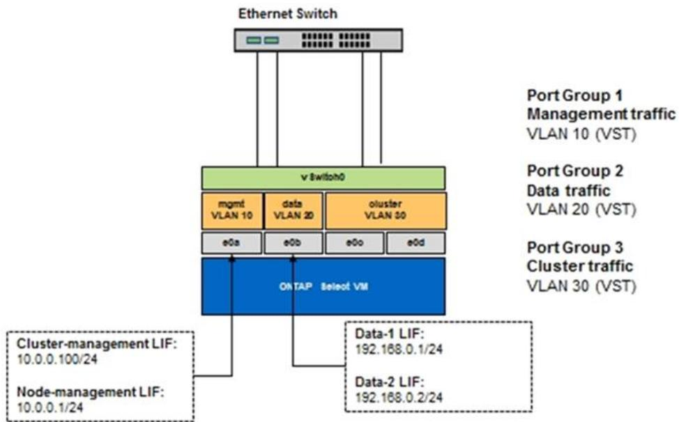
下图显示了第二种方案 VGT，在这种情况下，ONTAP VM 会使用放置在不同广播域中的 VLAN 端口对流量进行标记。在此示例中，虚拟端口 e0a-10/e0b-10/（e0c 或 e0g）-10 和 e0a-20/e0b-20 位于 VM 端口 e0a 和 e0b 的顶部。此配置允许直接在 ONTAP 中执行网络标记，而不是在 vSwitch 层执行。管理和数据 LIF 放置在这些虚拟端口上，从而可以在一个 VM 端口中进一步细分第 2 层。集群 VLAN（VLAN ID 30）仍会在端口组上进行标记。
