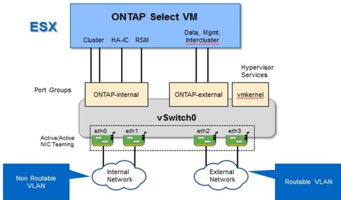
隔离不同物理网卡的内部和外部流量可防止对网络资源的访问不足，从而将延迟引入系统。此外，通过 NIC 组进行聚合允许 ONTAP Select 集群节点在单个网络适配器发生故障时继续访问网络。
