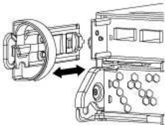
4. 如果您在拔下缆线后将 SFP 模块留在系统中，请将其移至新控制器模块。
