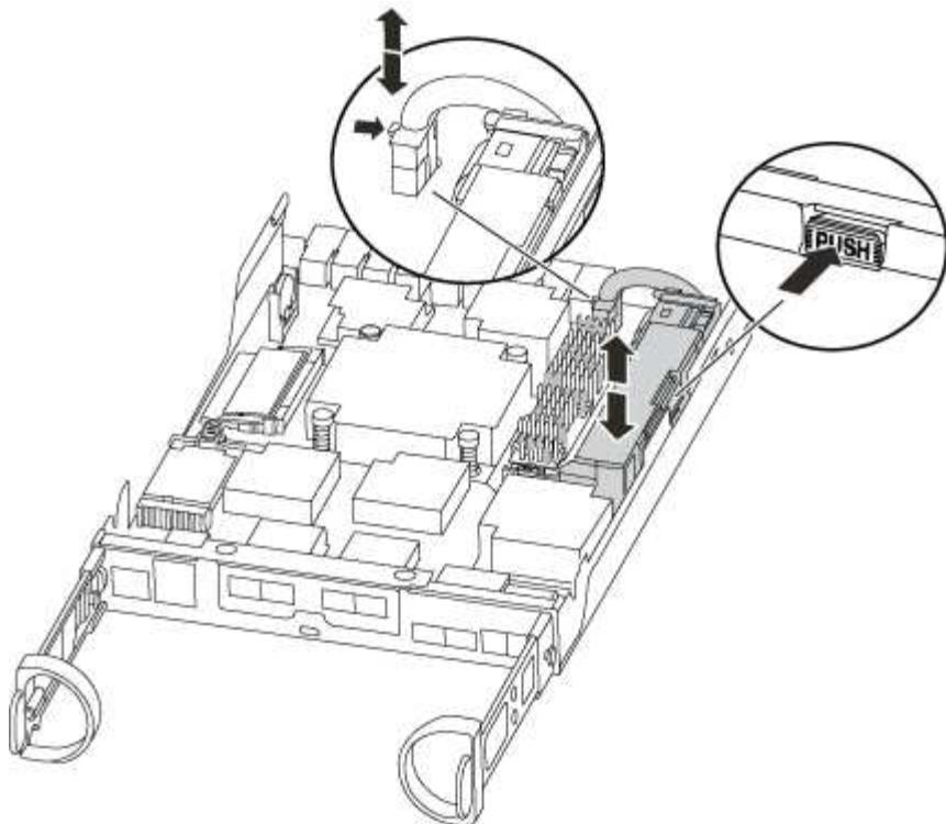
3. 找到电池插头，然后挤压电池插头正面的夹子，将插头从插槽中释放，然后从插槽中拔下电池缆线。
