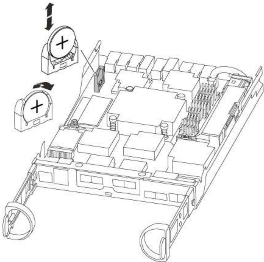
3. 将电池轻轻推离电池架，将其旋转出电池架，然后将其从电池架中取出。
