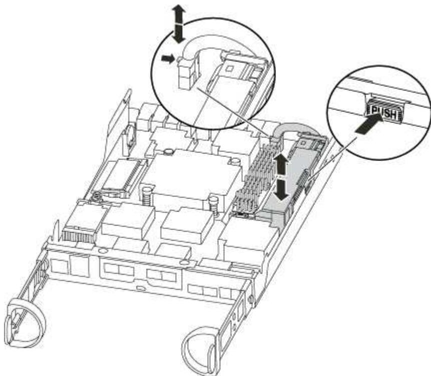
4. 找到电池插头，然后挤压电池插头正面的夹子，将插头从插槽中释放，然后从插槽中拔下电池缆线。
