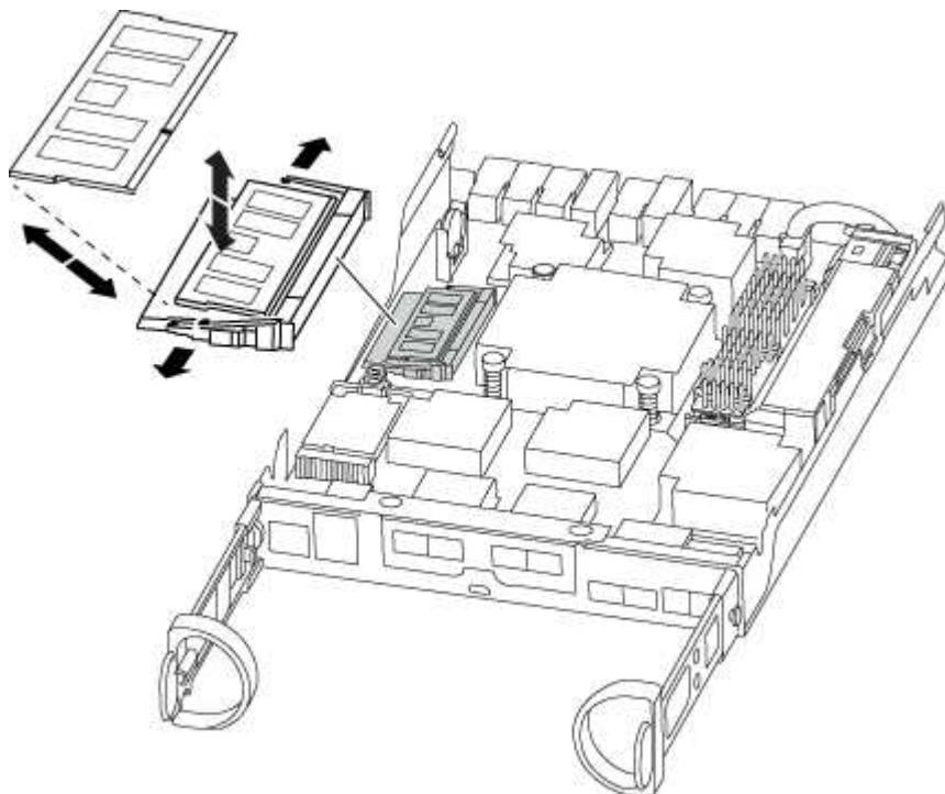
9. 从防静电运输袋中取出更换用的 DIMM，拿住 DIMM 的边角并将其与插槽对齐。
