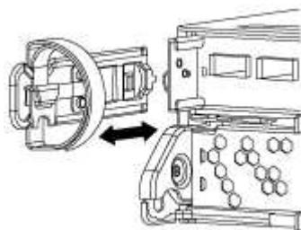
4. 按压凸轮把手上的闩锁，直到其释放为止，完全打开凸轮把手以从中板释放控制器模块，然后用两只手将控制器模块拉出机箱。
