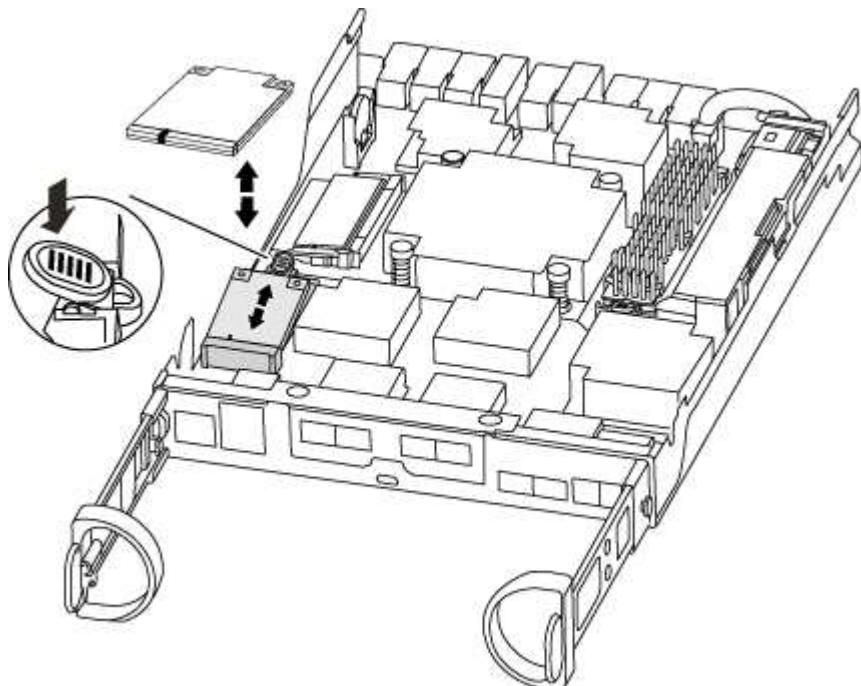
2. 按启动介质外壳上的蓝色按钮，将启动介质从其外壳中释放，然后将其竖直拉出启动介质插槽。
