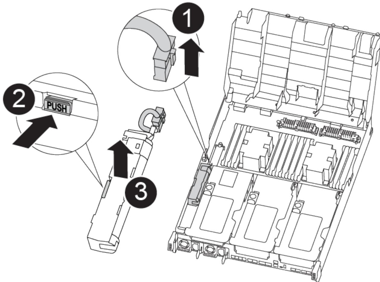
1. 找到电池插头，然后挤压电池插头正面的夹子，将插头从插槽中释放，然后从插槽中拔下电池缆线。
