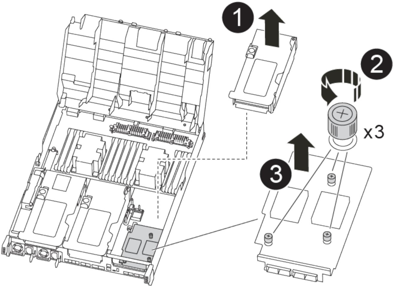
1. 将受损控制器模块中的一个和两个 PCIe 提升板移至替代控制器模块：
