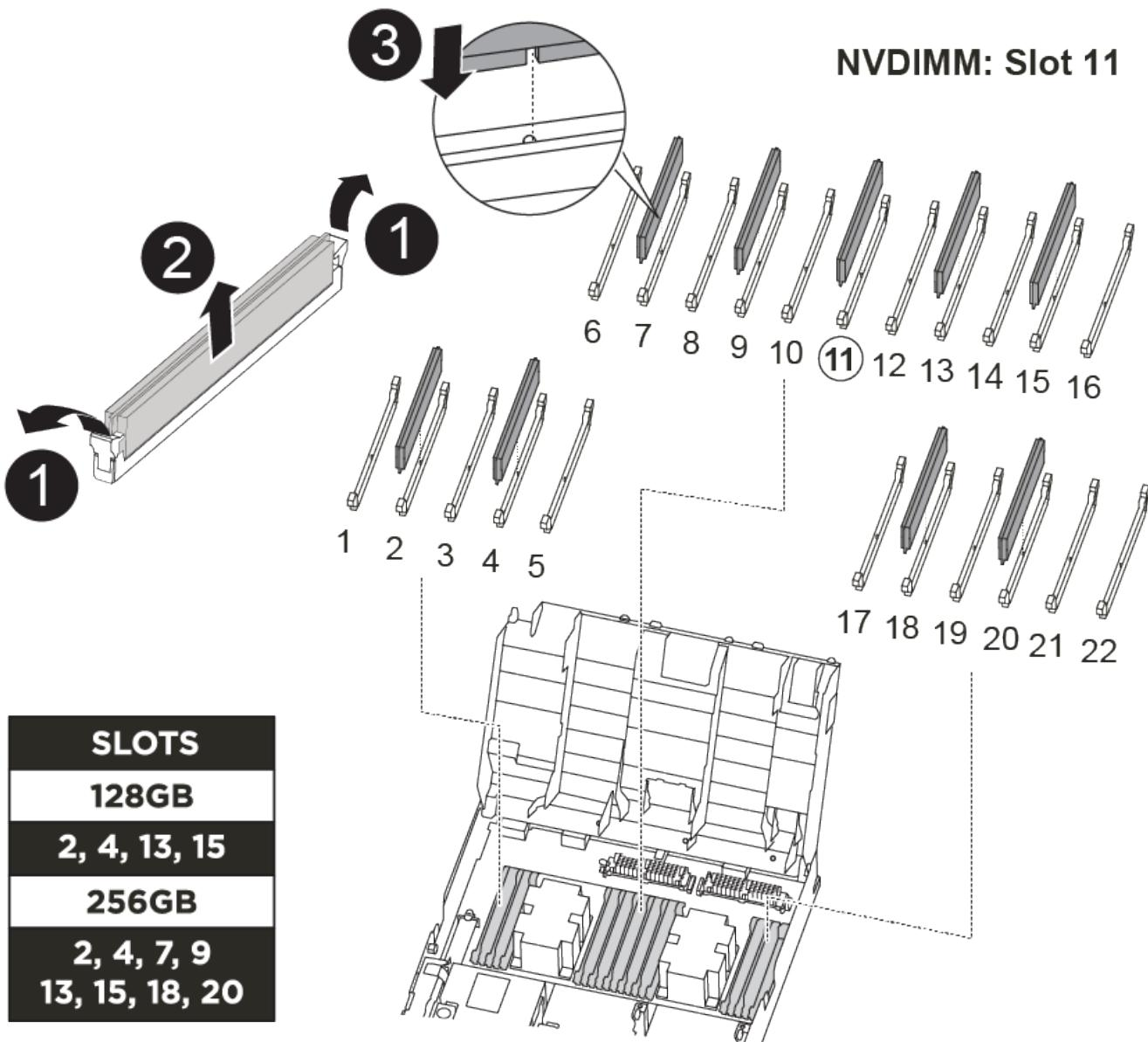
1. 找到控制器模块上的 DIMM。
