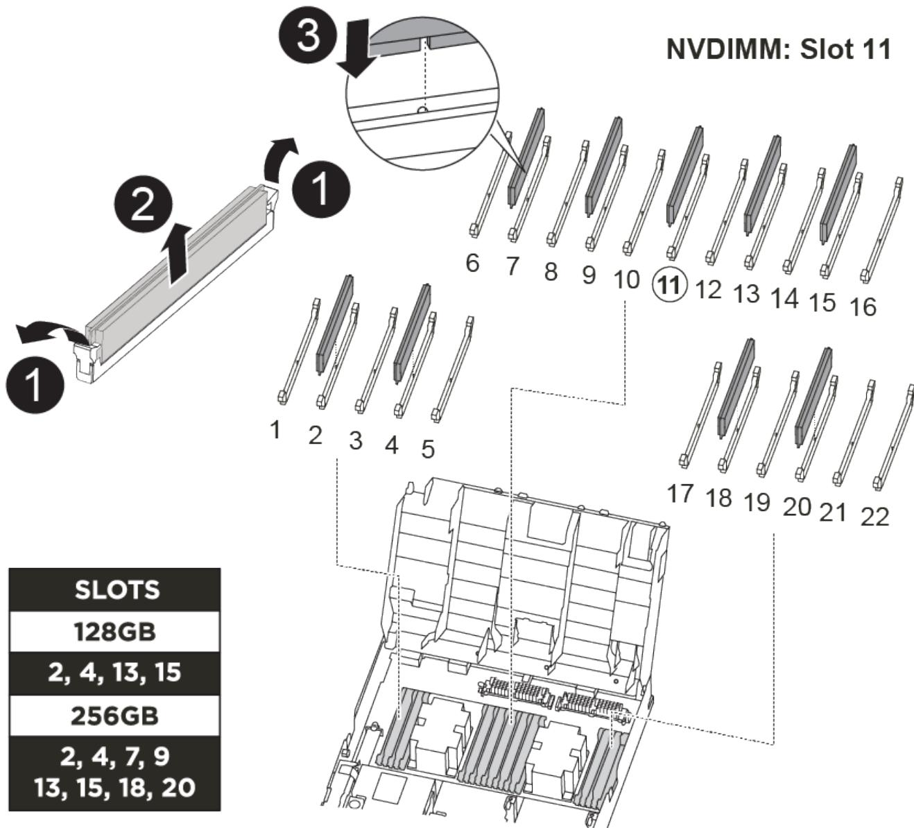
系统中 DIMM 的数量和位置取决于系统的型号。有关详细信息，请参见通风管上的 FRU 示意图。
