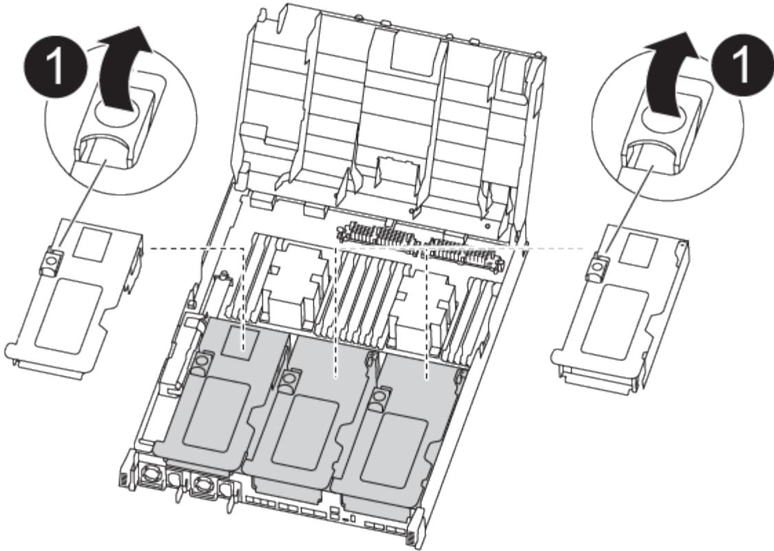
1. 将通风管两侧的锁定片朝控制器模块中间按压。
